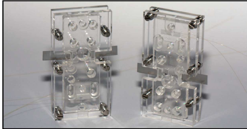
FIGURE 5.13 – Puce microfluidique intégrée avec les 2 pointes magnétiques et les 2 fibres optiques, comprise entre les 2 plaques de PMMA.
