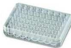
FIGURE 2.3 – Photo d'une plaque en plastique utilisée pour les tests ELISA (13 cm \times 9 cm).
