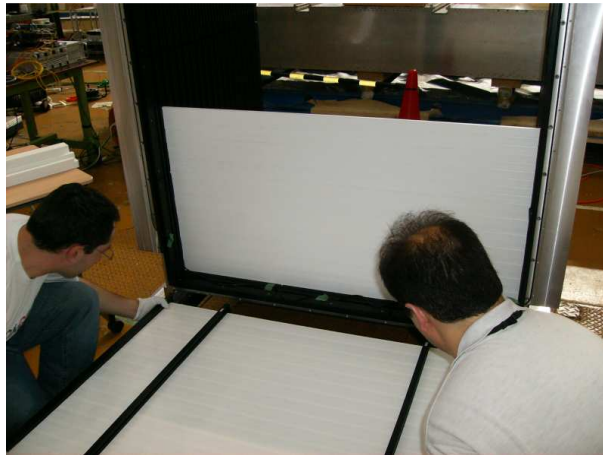
FIGURE F.4 – Insertion du plan de veto bas sous le module.
