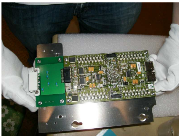
FIGURE F.2 – Fixation d'une carte électronique TFB à son support
