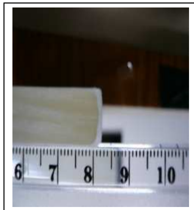
FIGURE 13.6 – Coupe d'un scintillateur. La partie jaune pâle correspond à la zone active, et la couche blanche à l'enduit.
