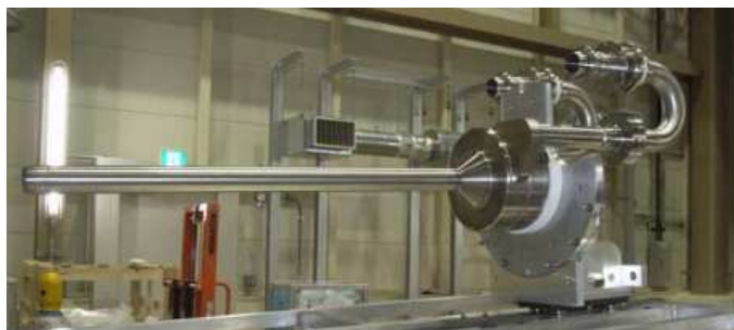
FIGURE 5.2 – La cible de T2K sur son support permettant l'insertion dans la première corne.
