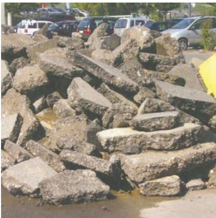
Fig. I-8 : plaques d'enrobé Illustration empruntée (Road Recycling Magazine)
