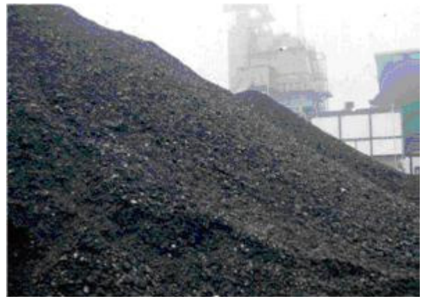
Fig. I-9 : agrégats d'enrobé après constitution d'un lot obtenu par concassage et criblage de déchets de bitumineux
