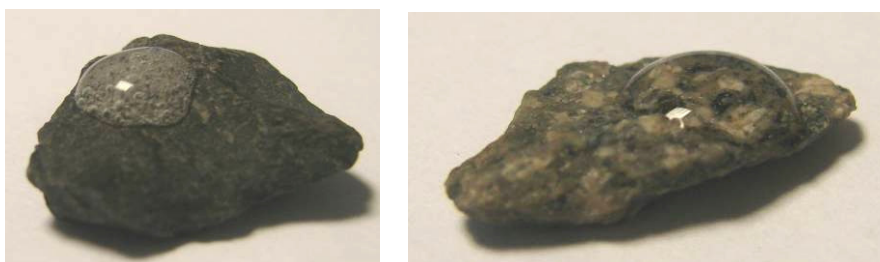
Présence (gauche) et absence (droite) d'effervescence lors d'un test à l'acide chlorhydrique sur un granulat.
