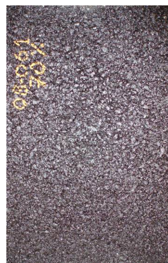
Plaques d'enrobé réalisées en vue de la fabrication d'éprouvettes pour la réalisation des essais à la machine Wehner & Schulze
