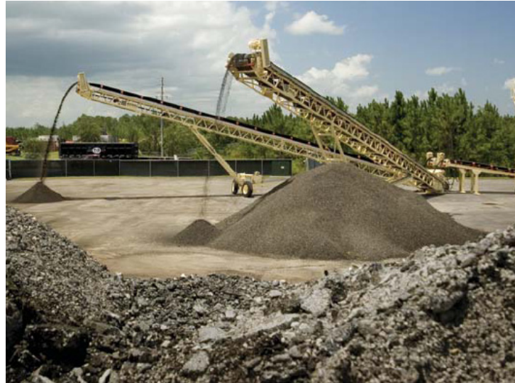
Fig. I-13 : fractionnement des agrégats d'enrobé (Hot Mix Magazine)
