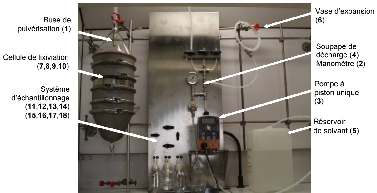
Fig. III-2 : dispositif expérimental de lixiviation
