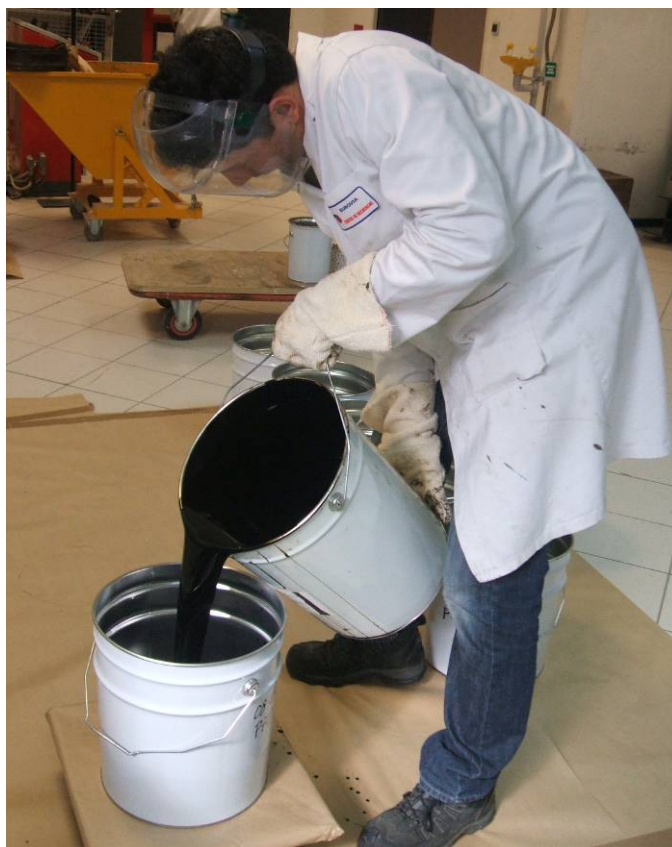
Opérateur réalisant le mélange des liants 35/50 et 160/220. Le contrôle des proportions est réalisé par pesées (balance non visible située en dessous du pot)
