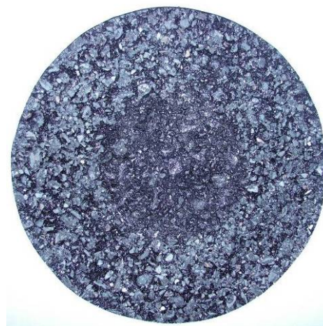
Éprouvette à 45 % de recyclage de 225 mm de diamètre et de 40 mm d'épaisseur après la réalisation de l'essai W&S
