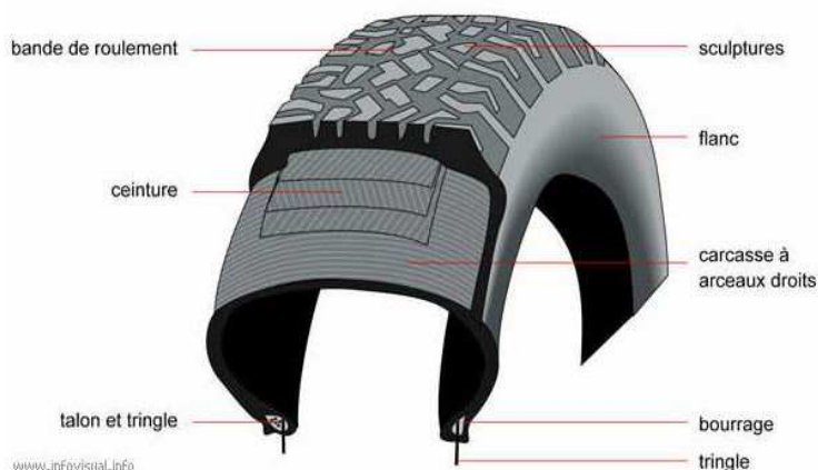
Figure I.1 : Schéma d'un pneumatique radial. Extrait de www.infovisual.info
