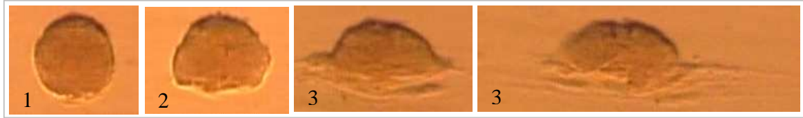
Figure V.5 : Séquences de délitement d'un agglomérat de silice Z1115MP totalement infiltré, ( R_0=35 \mu\text{m} , \dot{\gamma}=95 \text{ s}^{-1} , \tau_C^D=342 \text{ kPa} ) dans une matrice SBR, extrait de [ROU 08]
