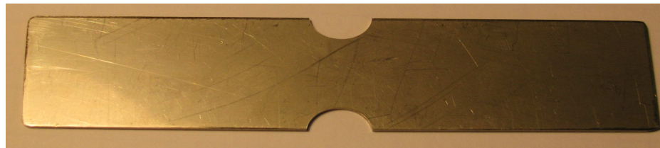
Figure 94 : éprouvette en acier inox utilisée pour les essais de traction à froid
