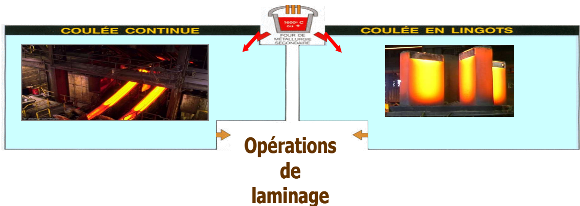
Figure 1 : les deux grandes voies de production des aciers
