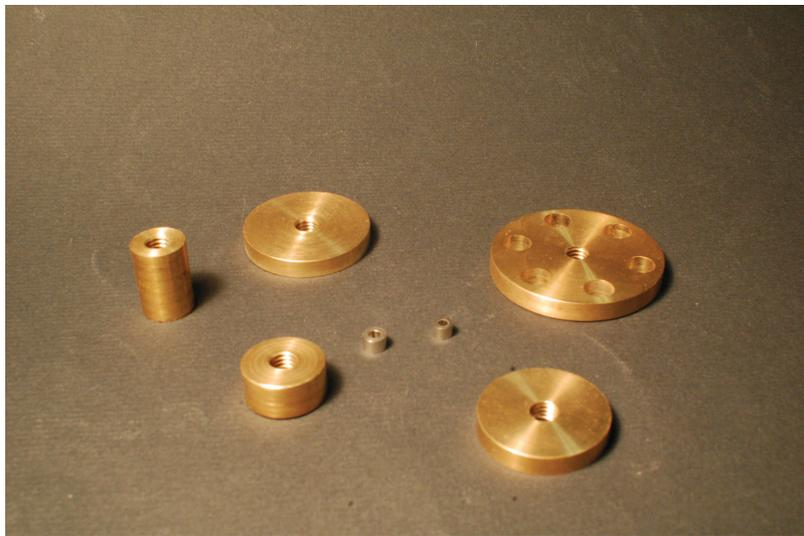
**FIGURE 2.4** – Les six intrus utilisés au cours de nos expériences sont plus larges que les grains constituant notre milieu modèle. Ne sont présent à l'image que cinq des six intrus utilisés. Leur taille vont de 7,88 à 2,36 diamètres de gros grain  $D_g$ ,  $D_g$  mesurant 5 mm. Tous sont en laiton.
