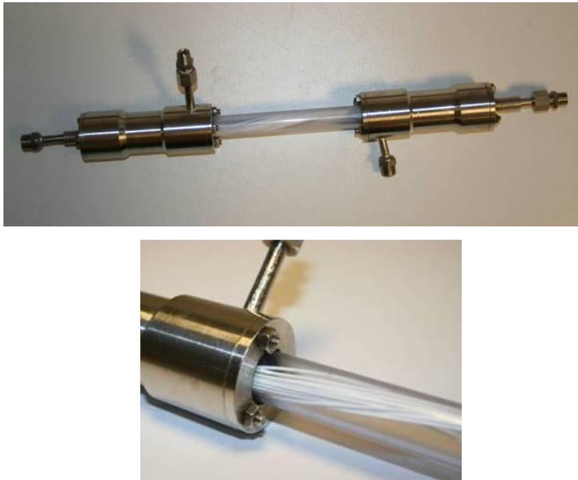
Figure II-8 : Photographies du module de fibres creuses en PTFE (Markel, Ederna).
