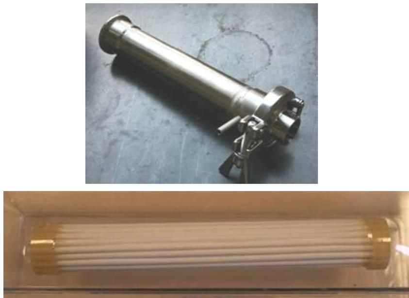
Figure II-9 : Photographies du module de fibres creuses en alumine hydrophobe (Hyflux, Surfactis).
