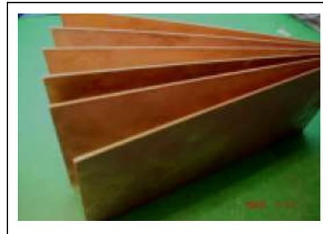
**Figure I.27 :** Colaminés en Cu-Mo pour substrat [46]
