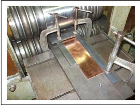
**Figure III.38:** Echantillon multicouche à l'entrée du laminoir
