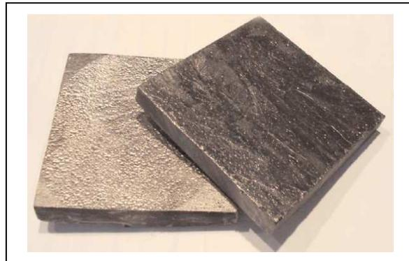
**Figure I.20 :** Graphite à haute conductivité [39]
