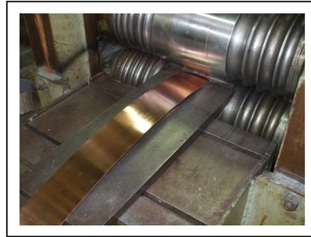
**Figure III.39:** Echantillon multicouche à la sortie du laminoir
