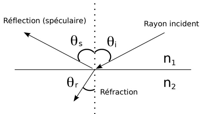
FIGURE 7.1 – Réflexion et réfraction de la lumière à l’interface entre deux matériaux d’indices différents ( $n_1$  et  $n_2$ )
