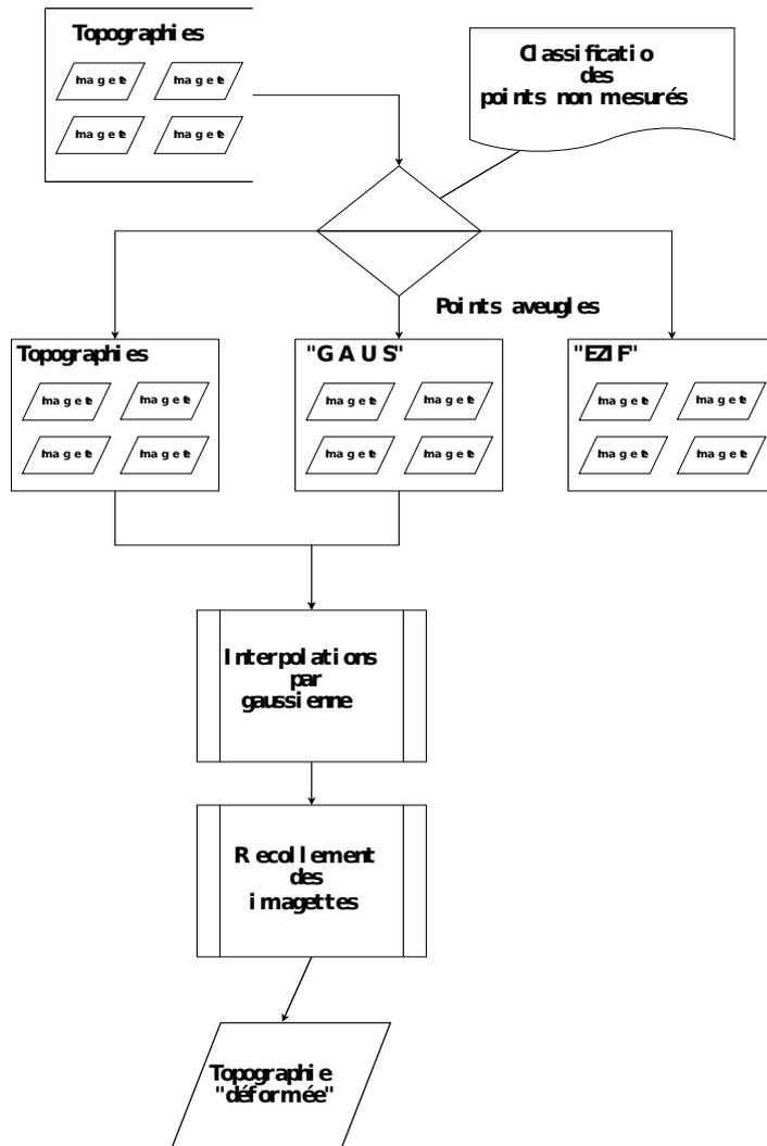
FIGURE 4.19 – Chaîne de restauration des topographies.
