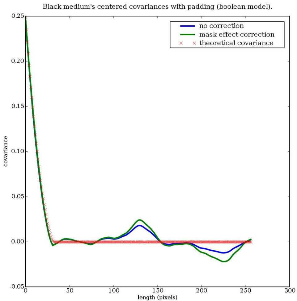
FIGURE A.12 – Conséquence de l'effet de masque sur l'allure de la courbe de covariance **centrée** d'un modèle booléen de disques. Notons que la formule utilisée pour décrire la courbe théorique n'est plus définie au-delà d'une longueur égale au diamètre du grain.
