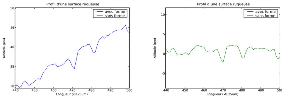
FIGURE 5.5 – Les agrandissements des profils de la figure 5.4 montrent bien que la morphologie du profil présentant une forme (à gauche) est très différente de celle du profil où la forme a été corrigée (à droite), même si, dans ce cas simplifié, il reste possible d’associer certaines portions des deux courbes
