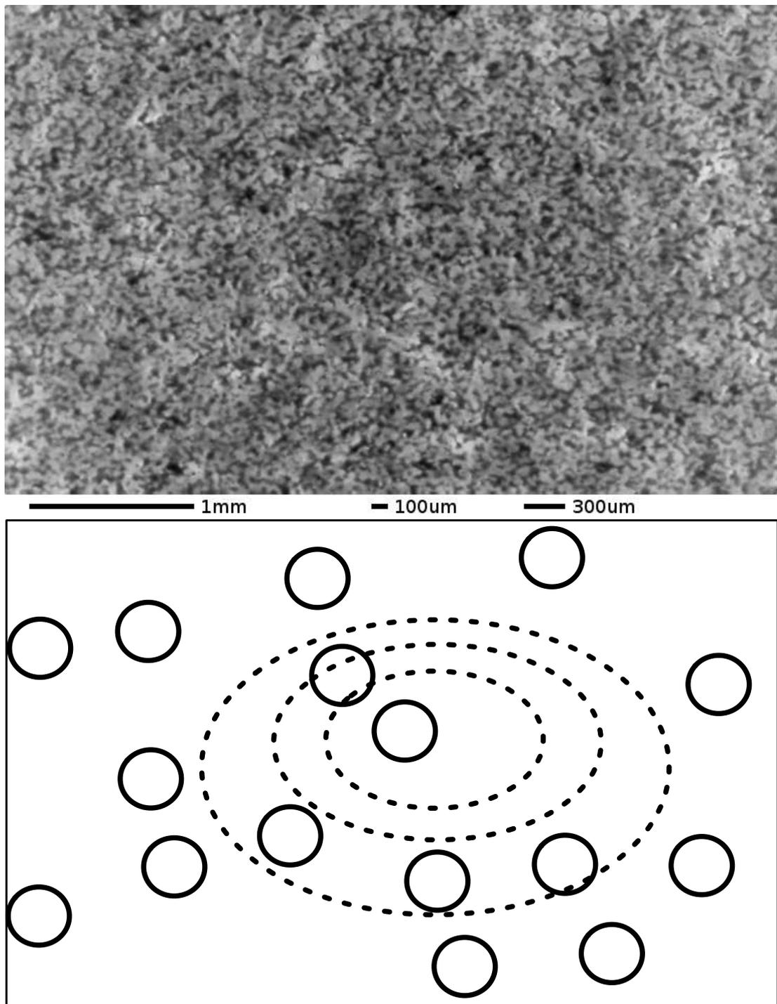
FIGURE 2.6 – Échantillon de tôle EDT, niveau de grandissement  $\times 1.6$ . Sur la carte du bas nous avons repéré les *monticules* les plus visibles par des cercles pleins et des courbes en pointillés figurent les lignes de niveau (approximatives) du creux visible au centre de l'image.
