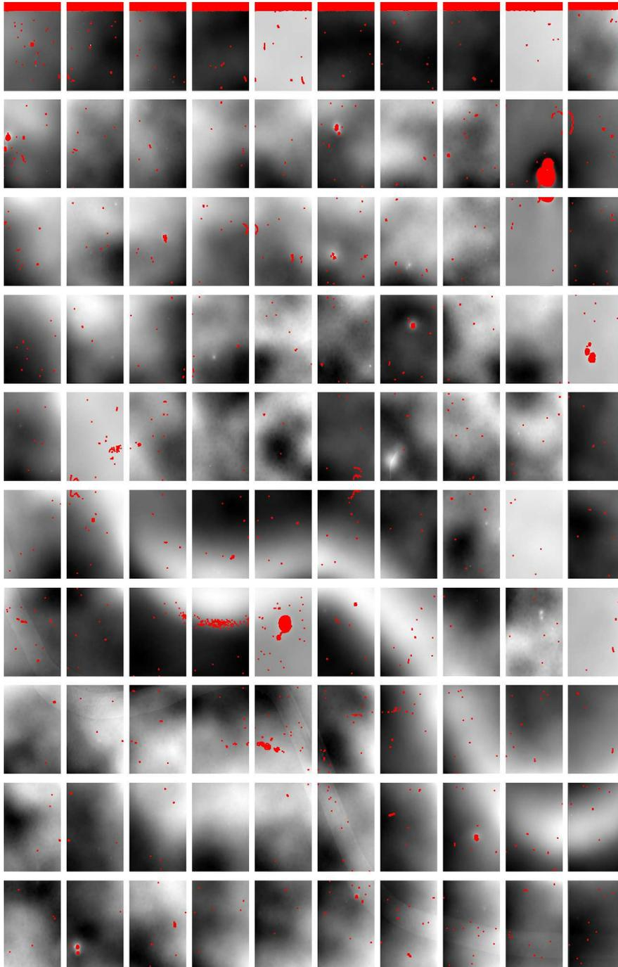
FIGURE 2.10 – Image mosaïque présentant le résultat d’une acquisition sur une tôle peinte en position inclinée à  $45^\circ$  (le bord le plus élevé lors du séchage est ici en haut de la page). Les 100 imageries sont ici présentées avec, en rouge les points non mesurés et, en niveaux de gris les altitudes qui sont mesurées dans des référentiels propres à chaque imagerie.
