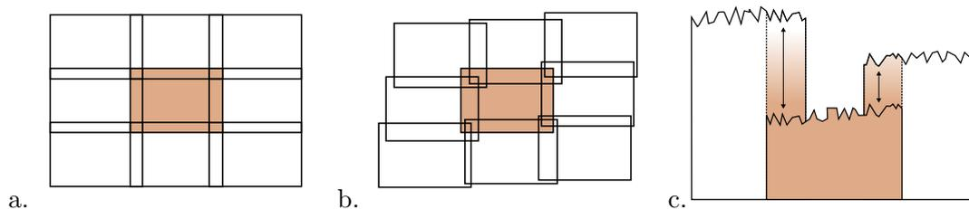
FIGURE 4.15 – Décalages entre imquettes : a. Disposition horizontale théorique avec un recouvrement. b. Arrangement désordonné observé en pratique. c. Écarts de niveaux de gris entre imquettes voisines.
