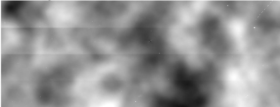
FIGURE 2.3 – Topographie d'une tôle EDT peinte
