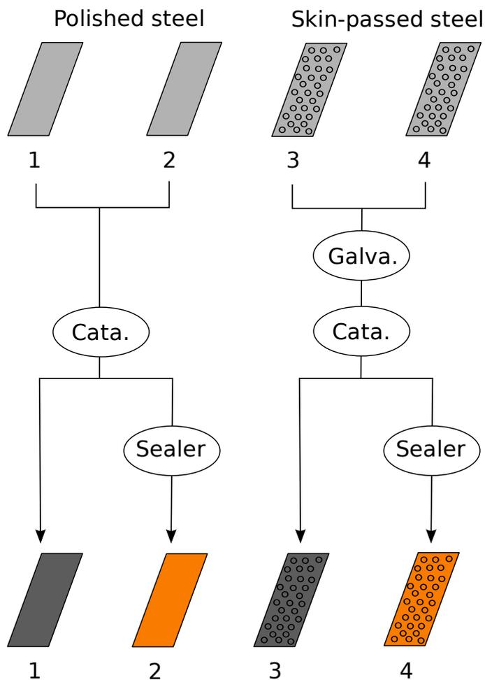
FIGURE 3.4 – Préparation des échantillons
