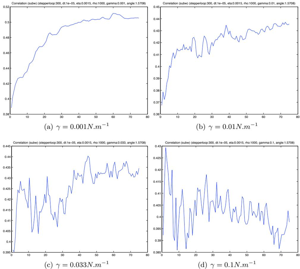
FIGURE 6.15 – Évolution du coefficient de corrélation entre la topographie simulée et la topographie réelle recouverte de sealer. L'échelle des temps indiqués en abscisses est de  $10^{-5} s$ . La corrélation entre les deux surfaces réelles (initiale et finale) est de 0.36.
