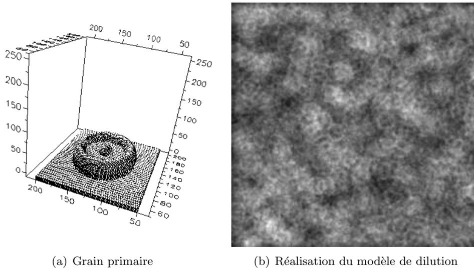
FIGURE 6.3 – Fonction de dilution pour laquelle le grain primaire correspond à une “lamellae”. (Visualisation faite avec Aphelion<sup>TM</sup>[65])
