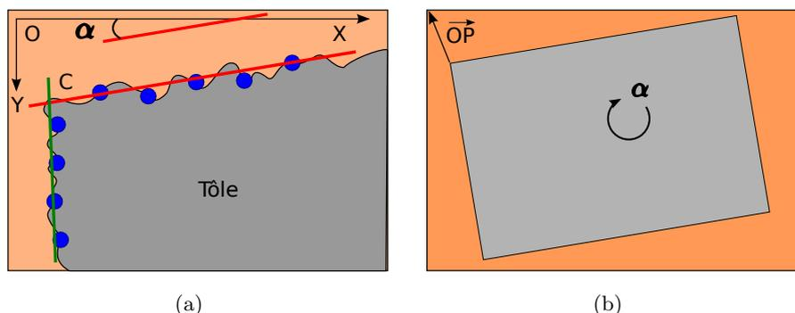
FIGURE 5.2 – Utilisation de régressions linéaires pour déterminer les paramètres des déplacements à appliquer lors de l'ajustement des bords du gabarit. Notons que sur l'image (a) les points bleus sont là pour symboliser les phases de régressions linéaires grâce auxquelles on obtient les droites rouge et verte, mais dans l'algorithme réel il n'y a pas eu de sous-échantillonnage des bords.
