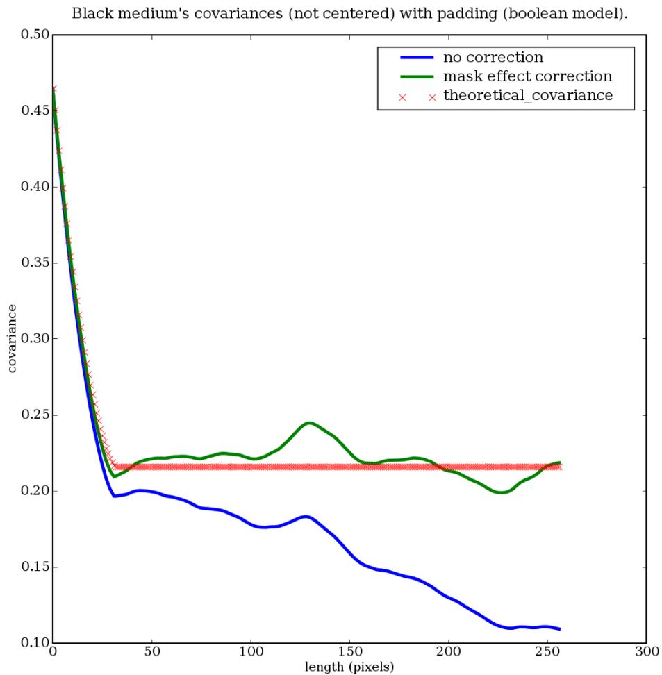
FIGURE A.11 – Conséquence de l’effet de masque sur l’allure de la courbe de covariance **non centrée** d’un modèle booléen de disques. Notons que la formule utilisée pour décrire la courbe théorique n’est plus définie au-delà d’une longueur égale au diamètre du grain.
