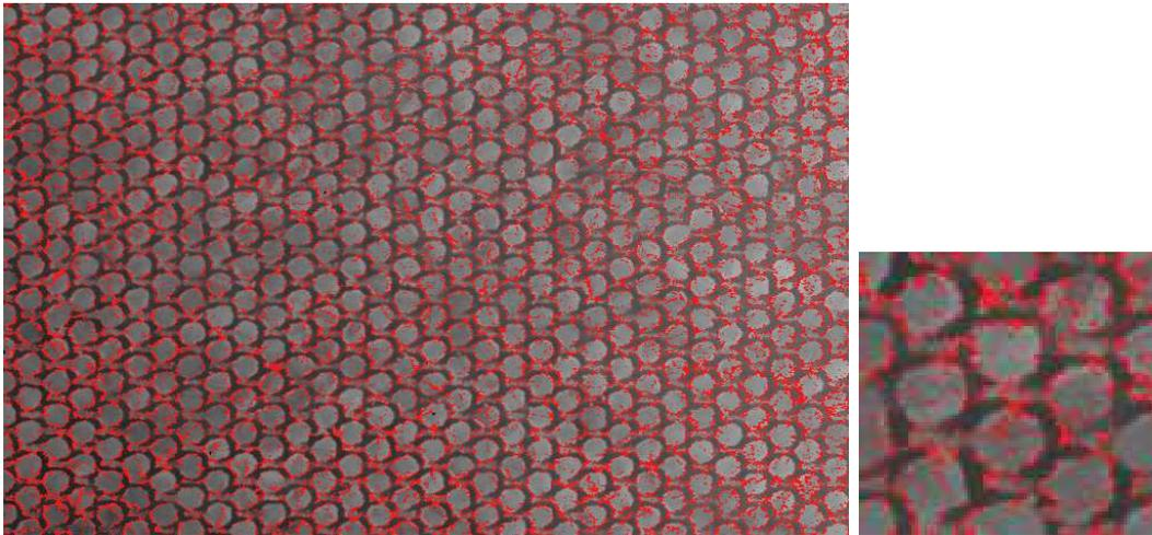
FIGURE 2.9 – Une des 100 imagettes acquises sur une tôle galvanisée de rugosité périodique. L’image fait  $749 \times 476$  pixels avec un pas de  $6.98 \times 8.25 \mu m^2$ . On voit ici les points non mesurés en rouge. À droite, un zoom sur l’image précédente.
