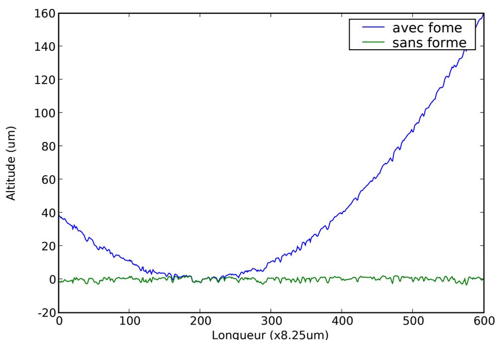
FIGURE 5.4 – Une illustration de ce qui est généralement désigné comme la forme d’un échantillon. Ici la forme a l’allure d’une parabole qui “déforme” le profil de rugosité. Nous avons aussi fait figurer le résultat attendu après une correction possible de cette forme.
