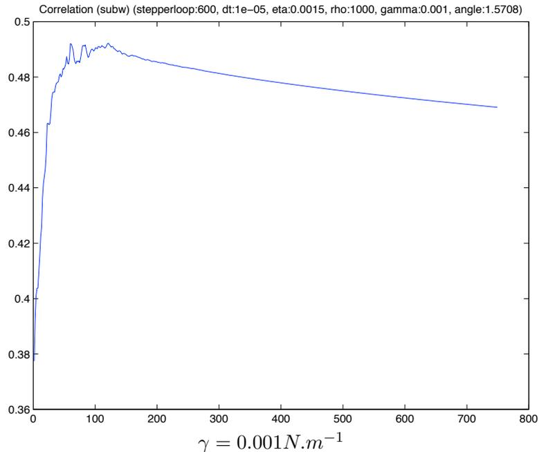
FIGURE 6.17 – Évolution du coefficient de corrélation entre la topographie simulée et la topographie réelle recouverte de sealer. L'échelle des temps indiqués en abscisses est de  $10^{-5}s$ . La corrélation entre les deux surfaces réelles (initiale et finale) est de 0.36.
