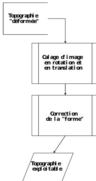
FIGURE 5.20 – Chaîne de mise en forme des topographies afin de les rendre exploitables.
