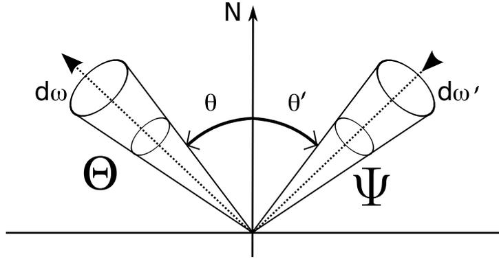
FIGURE 7.3 – Luminances émise (à gauche) et reçue (à droite). Sur cette figure,  $\Psi$  représente le cône d’incidence, et  $\Theta$  celui de l’émission. Alternativement,  $\Psi$ ,  $\Theta$  et  $N$  peuvent aussi être considérés comme des vecteurs pointant dans les directions indiquées sur le schéma.
