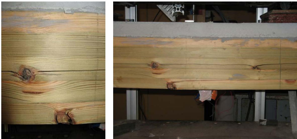
Figure 5.21. Rupture en traction au niveau d'un second nœud puis cisaillement
