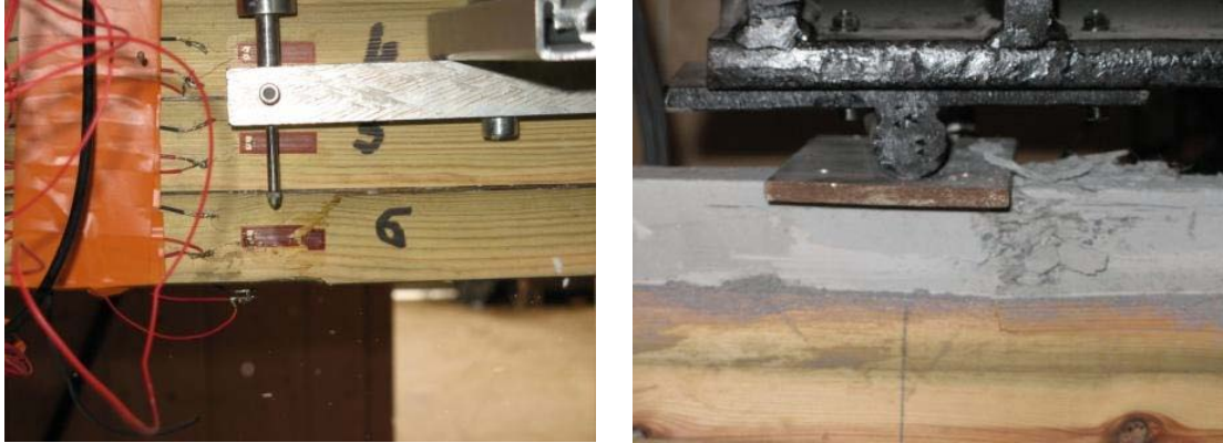
Figure 5.29. Rupture de la lame inférieure et compression du béton
