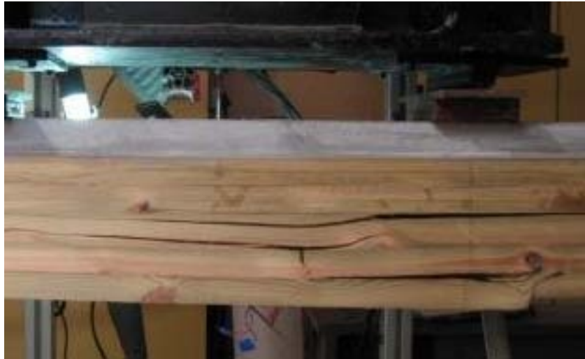
Figure 5.25. Rupture des lamelles du bois en traction
