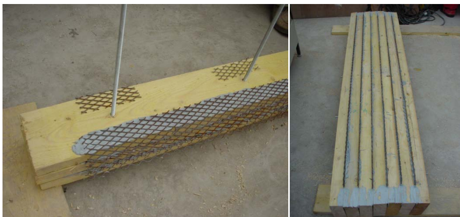
Figure 1.28. Connexion en métal déployé [De Noray, 2005]
