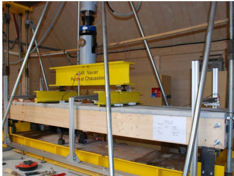
Figure 1.31. Corps d'épreuve bois-BFUP en cours d'essai de fatigue en flexion [Pham, 2007]
