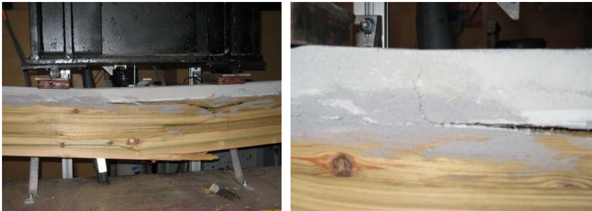
Figure 5.16. Ruine de la poutre et rupture du béton en traction
