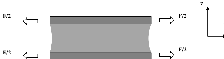
Figure 3.6. Schéma de calcul de l'essai en traction directe d'un assemblage 3 couches
