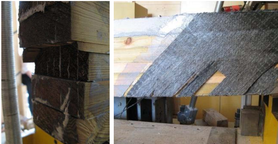
Figure 5.47. Ruine de la poutre en cisaillement et rupture du renfort carbone aux extrémités
