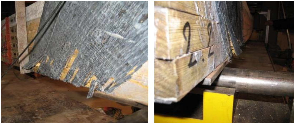
Figure 5.37. Rupture du renfort carbone en cisaillement
