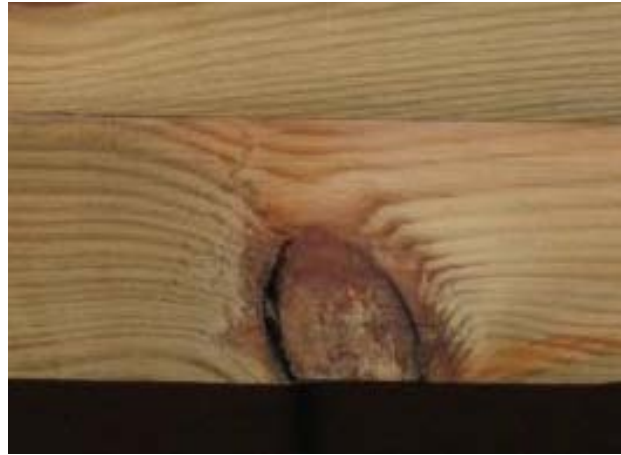
Figure 5.20. Rupture en traction à 56 kN
