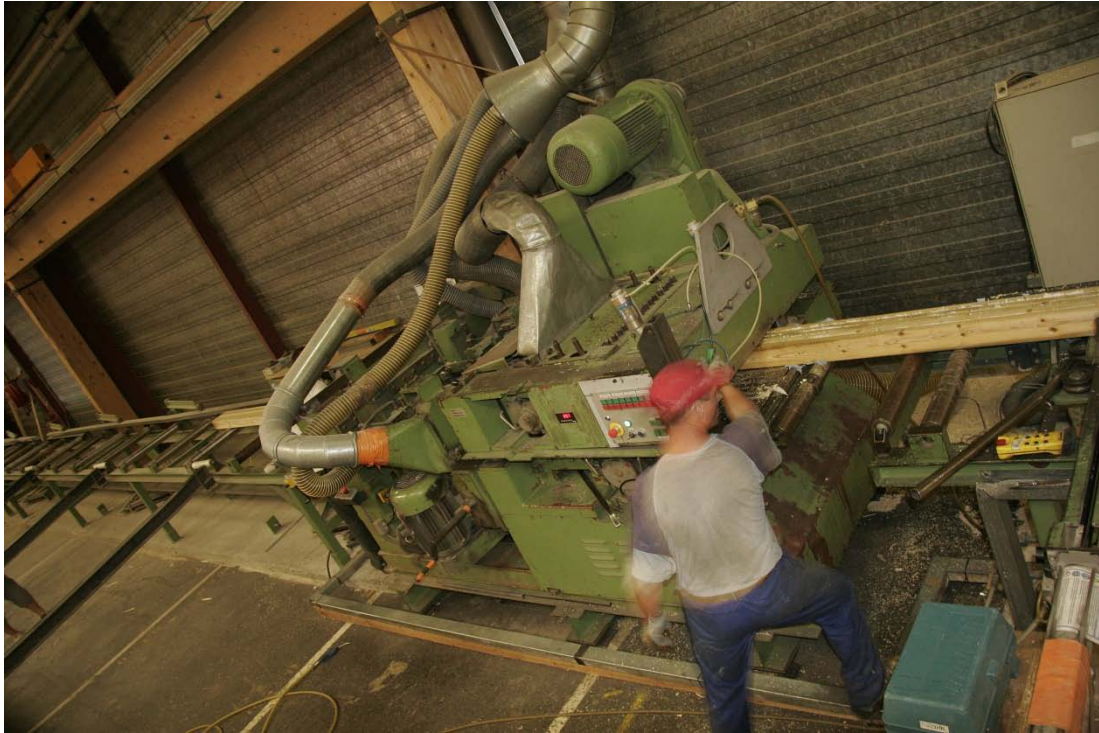
Figure 5.4. Rabotage des poutres après durcissement de la colle
