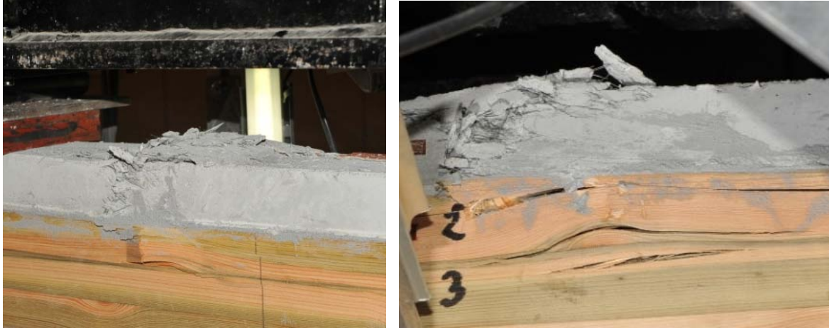
Figure 5.51. Plastification du béton par compression et ruine du bois
