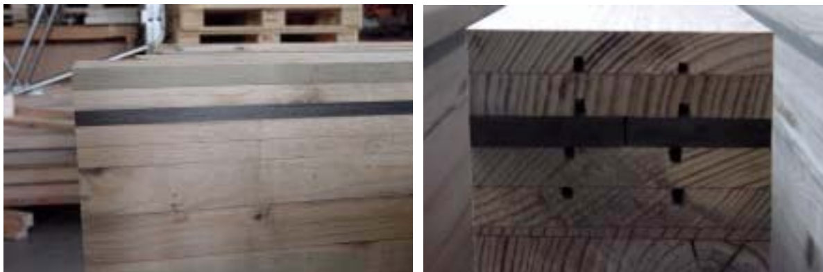
Figure 2.4. Le Carboglulam® [CBTA, 2003]
