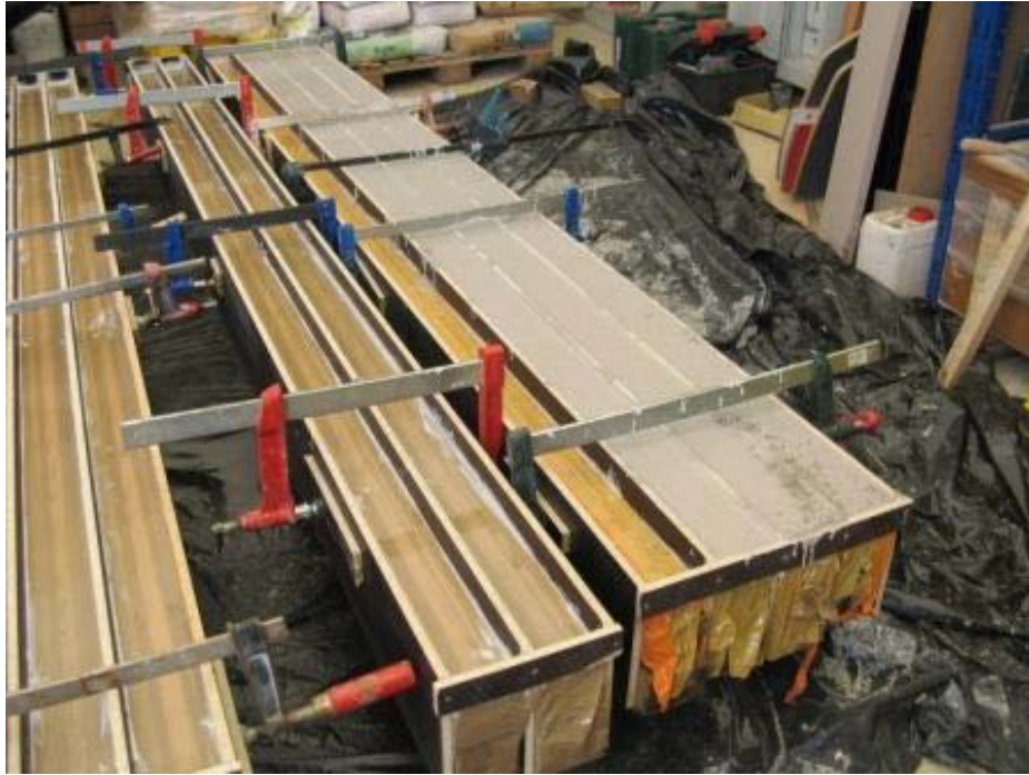
Figure 5.5. Coulage du béton BFUP
