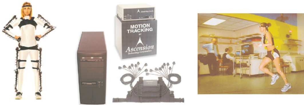
FIGURE 5.4 – Systèmes d’acquisition. A gauche, un système mécanique. A droite, un système optique (« Motion tracking »).
