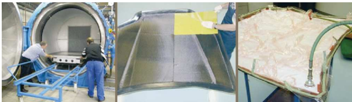
Figure 1-1 Equipement et outillage pour le moulage de préimprégnés. Source : AIRTECH
