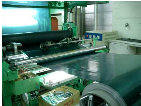
Figure 2-11 Fabrication des tissus préimprégnés [Fibersonixx 2010]
