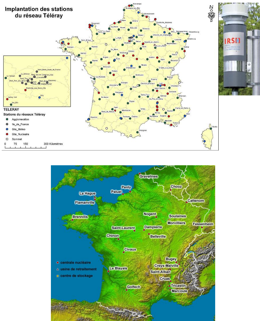
FIGURE 1.3 – La figure à gauche représente le réseau TELERAY. À droite, la photo d'une station de mesure du débit de dose gamma du réseau TELERAY. La figure d'en bas montre les installations nucléaires civiles de la France. Origine : IRSN
