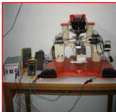
Figure 2.3 : Photo du montage sur un banc Karl Suss pour les mesures électrique des composants.
