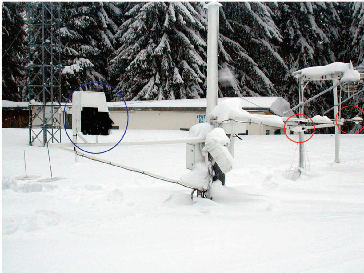
Fig. 1.3. Dispositif de mesure des rayonnements de courte et grande longueur d'onde, montants et descendants (rouge) et de leur système de nettoyage (bleu)
