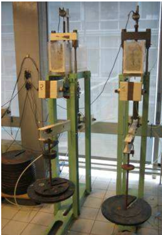
Figure 3-4: Schéma du bâti oedométrique haute pression (Marcial et al., 2002).
