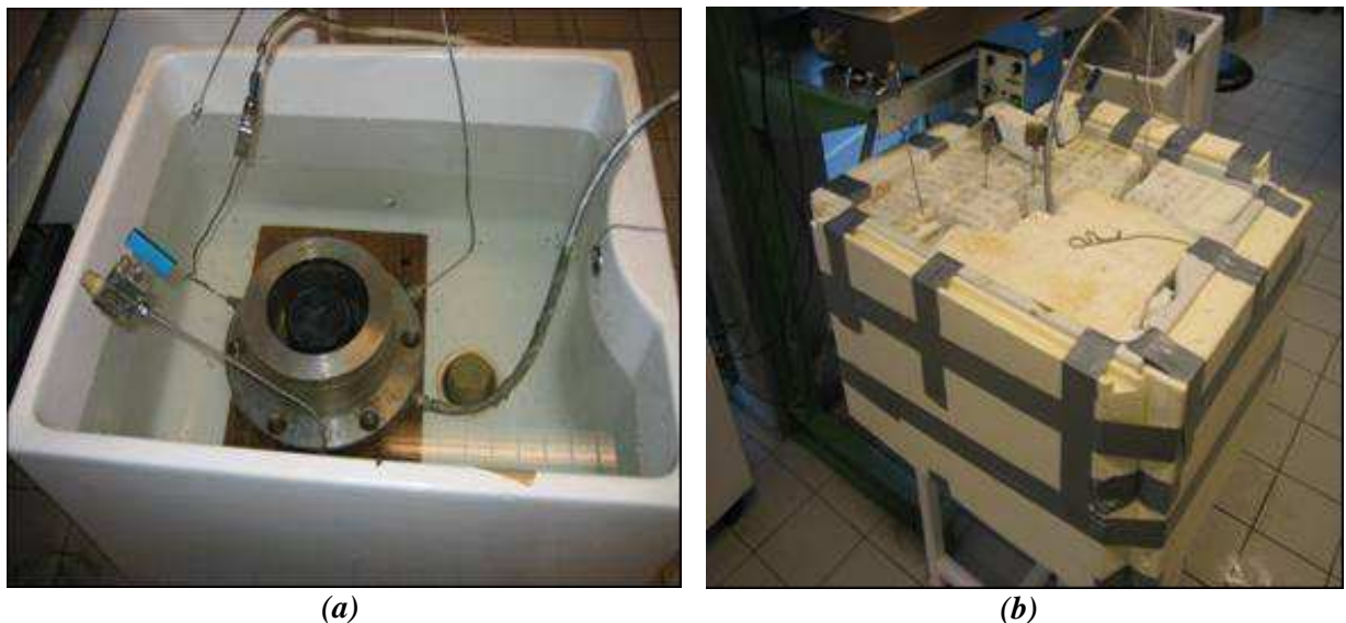
Figure 3-10: Poste d'essai de compression isotrope thermique.
