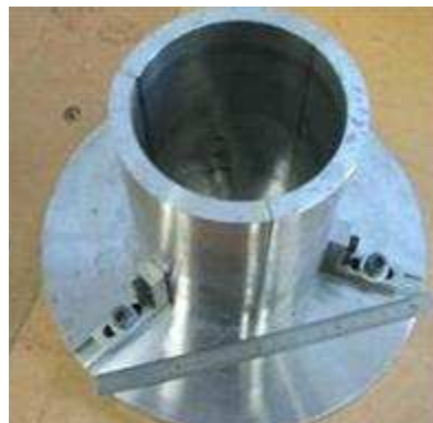
Figure 3-26: Système de confinement spécial de l'éprouvette cylindrique creuse.
