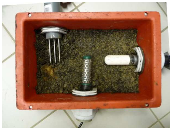
Figure VI-23 : Etalonnage de la sonde SIS dans le sol prélevé sur le site de Moulin Blanc
