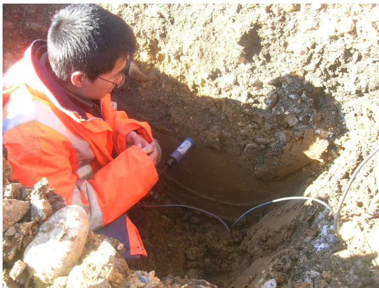
Figure II-14 : Mesure de la teneur en eau volumique par sonde Thétaprobe
