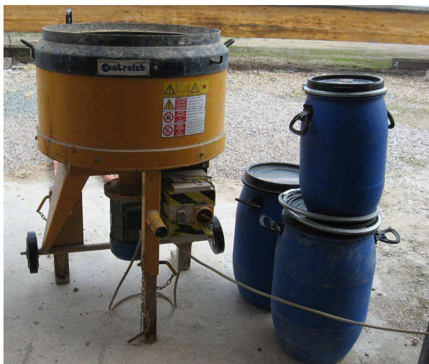
Figure III-7 : Malaxeur et bidons de stockage des matériaux
