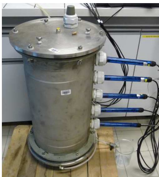
Figure III-17 : Etalonnage de la sonde TDR – Drainage de l'eau par paliers
