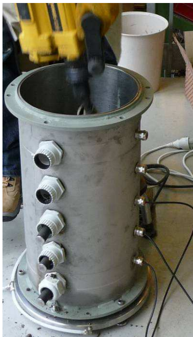
Figure III-8 : Compactage de l'échantillon
