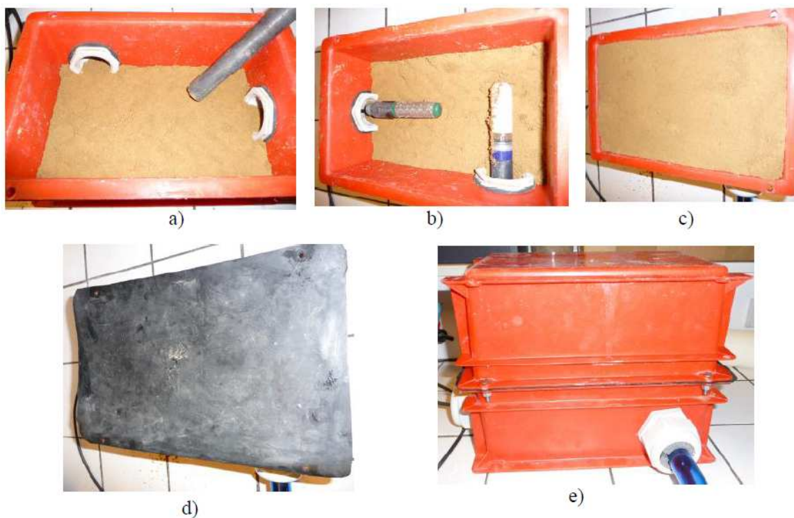
Figure VI-21 : Procédure de l'essai d'étalonnage de la sonde SIS
