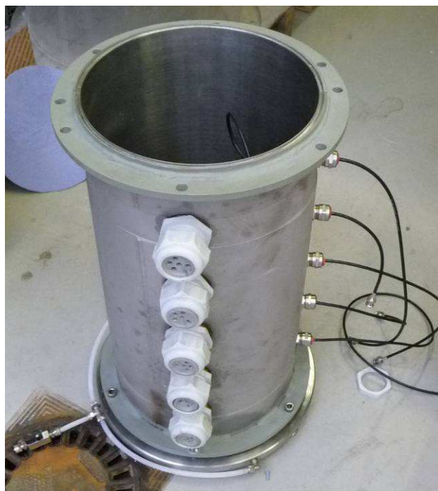
Figure III-3 : Vérification de l'étanchéité de la colonne
