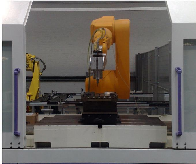
FIGURE 3 – Robot 6-axes équipé d'une électrobroche UGV
