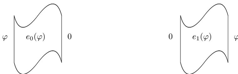
FIGURE 5.6 – Illustration des conditions aux limites pour les problèmes de cellule
