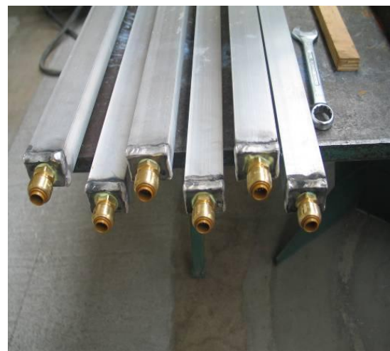
Figure 69 : Amas de tubes avec les raccords tectites
