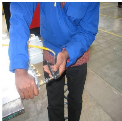
Figure 73 : Injection d'air comprimé dans les tubes
