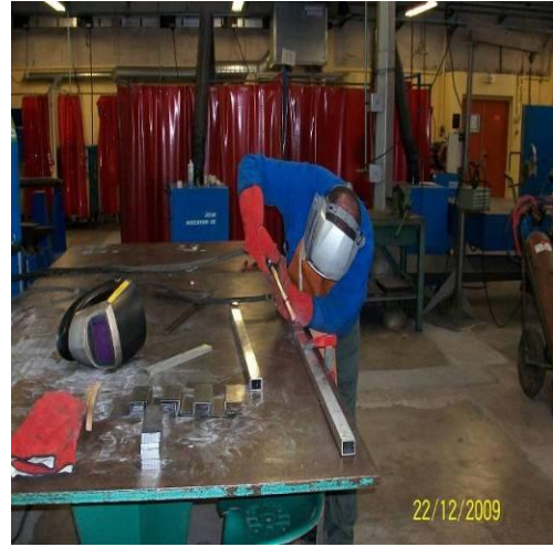
Figure 63 : Assemblage des chutes de tubes par soudure
