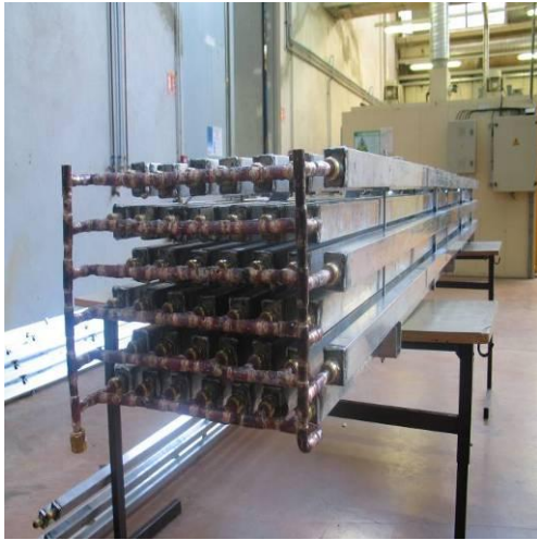
Figure 86 : vue de face d'un échangeur
