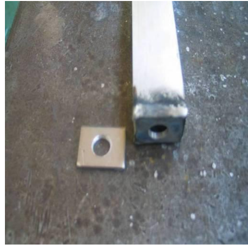
Figure 67 : Plaques avant taraudées et soudées sur les tubés découpés ou assemblés
