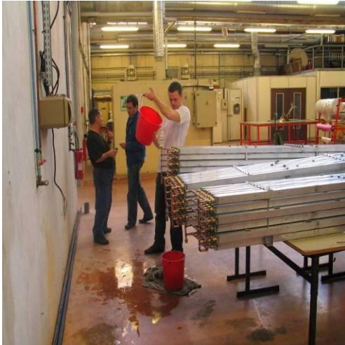
Figure 88 : Remplissage d'eau des échangeurs pour les tests d'étanchéité
