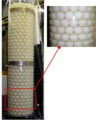
Figure 25 : Système de rafraîchissement mis au point par d'Arkar et al. (d'après Arkar et al, 2005, 2007).
