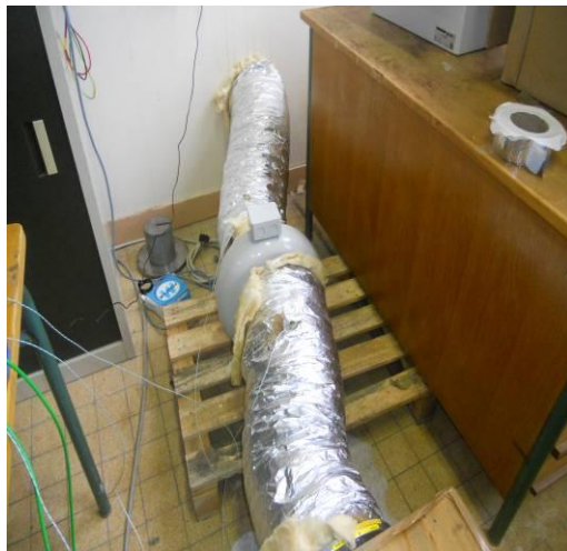
Figure 102 : Circuit aéraulique du dispositif expérimental (ventilateur+gaines)
