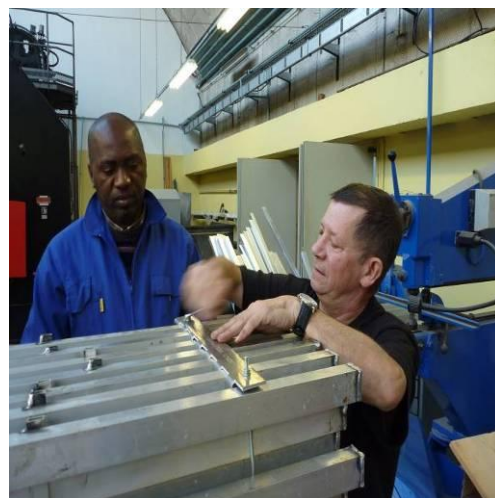
Figure 85 : Montage de la pièce de maintien des contenants MCP
