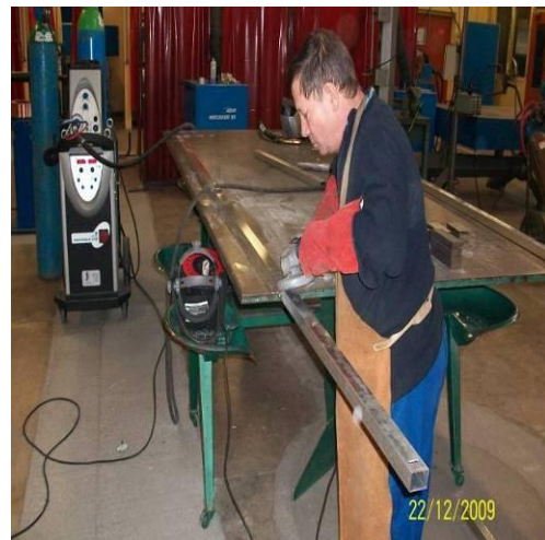
Figure 65 : Ebavurage des soudures par abrasion
