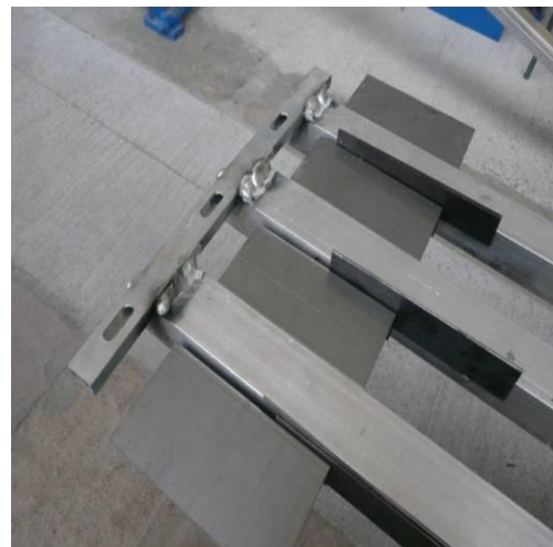
Figure 80 : Assemblage des tubes pour le remplissage de la première solution de remplissage
