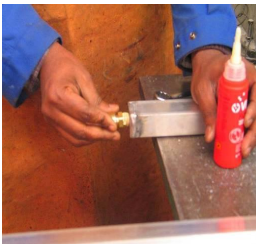
Figure 68 : Fixation des raccords tectites
