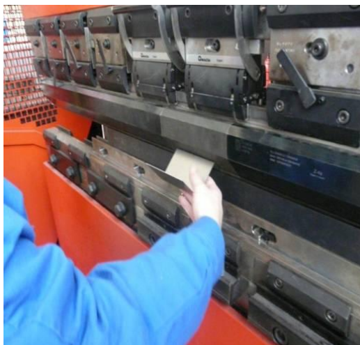
Figure 74 : Fabrication des déflecteurs
