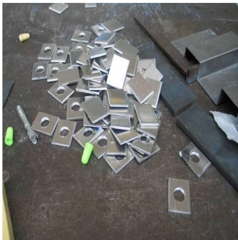
Figure 64 : Plaques avant et arrière taraudées
