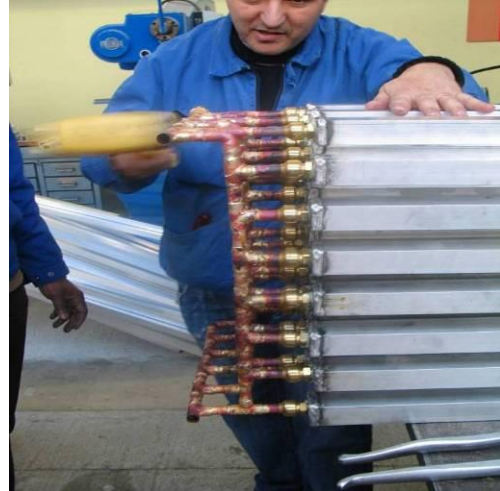
Figure 83 : Réglage de la dernière colonne de contenant MCP sur le dispositif de remplissage, de dilatation et de vidange des contenants MCP.
