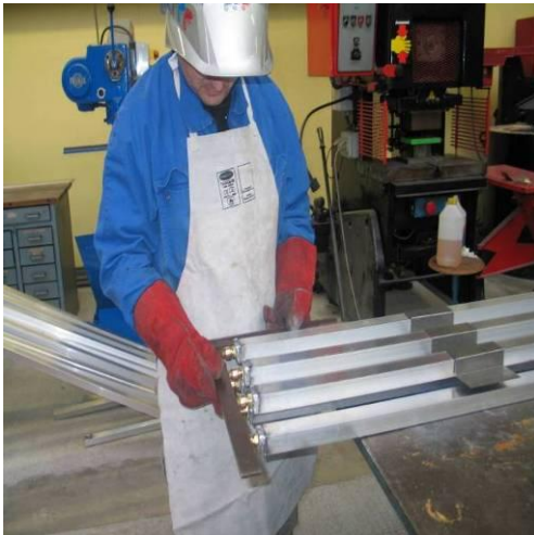
Figure 70 : Réglage du montage d'une colonne des contenants des MCP
