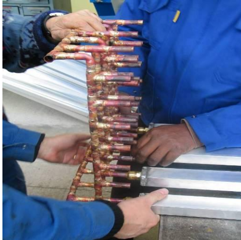
Figure 82 : Montage de la première rangée de contenant MCP sur le dispositif de remplissage, de dilatation et de vidange des contenants MCP
