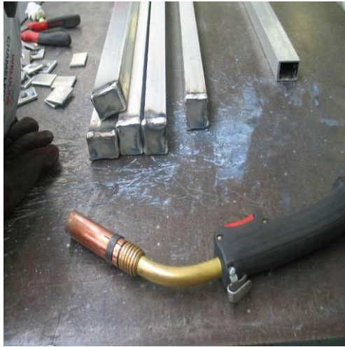
Figure 66 : Plaques arrières soudés les tubes découpés ou assemblés
