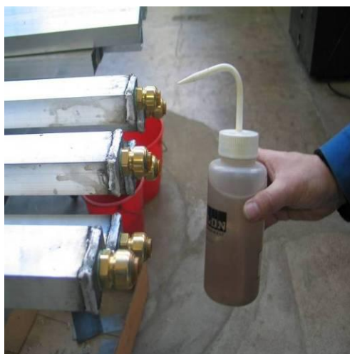
Figure 72 : Remplissage d'eau dans les tubes
