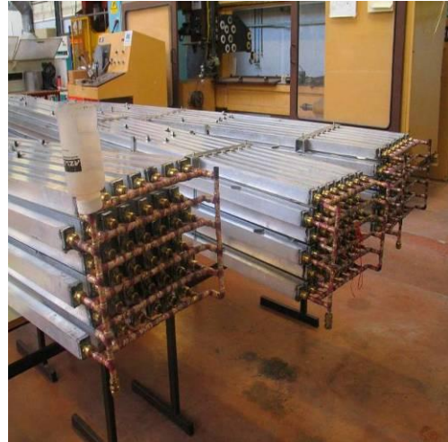
Figure 89 : phase de 2 h d'attente pour tester l'étanchéité
