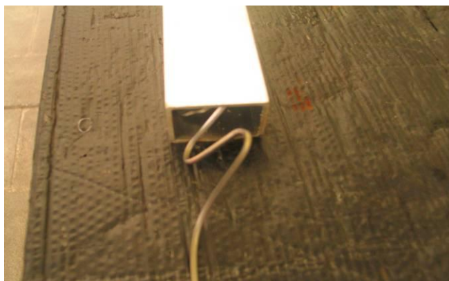
Figure 94 : Insertion du fil de fer à l'intérieur du tube pour améliorer la conductivité du MCP
