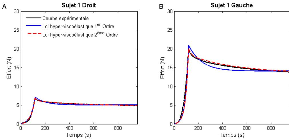
**Figure 35 : Courbes effort en fonction du temps pour la phase de traction et de relaxation**
