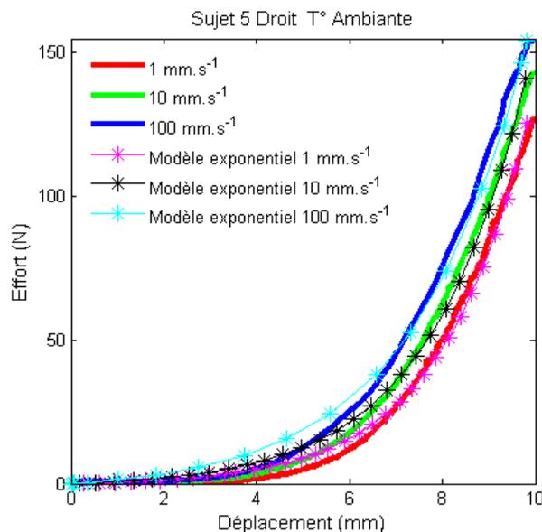
Figure 56 : Courbes effort déplacement pour le muscle droit du sujet 5, dans des conditions expérimentales ambiantes d'air et de température pour les trois vitesses testées.
