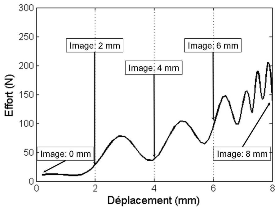
Figure 49 : Images successives pendant l'essai de traction à différents déplacements repérés sur la courbe effort-déplacement (fréquence 5000 Hz) – Muscle droit du sujet 1
