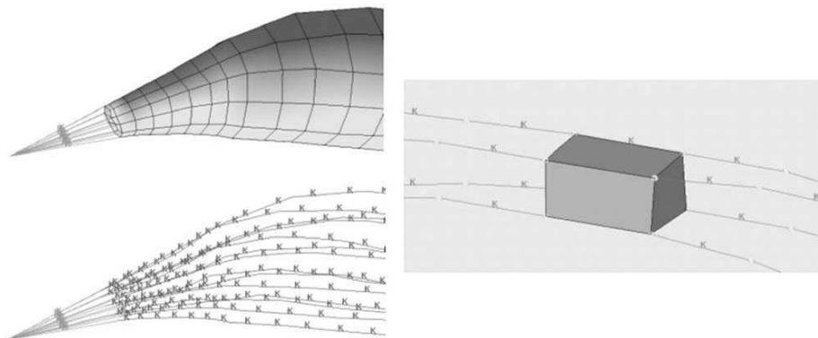
**Figure 20 : Modélisation en éléments finis du muscle avec câbles actifs D'après Behr et coll., 2006**
