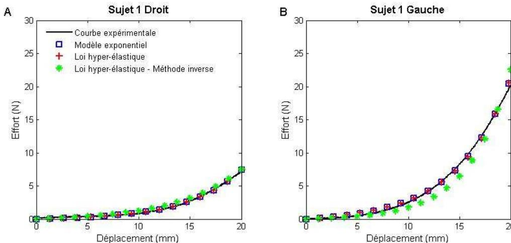
**Figure 31 : Courbes effort déplacement pour la phase de traction ; Modèle exponentiel, Loi hyper-élastique, Loi hyper-élastique par méthode inverse. A. Muscle droit du sujet 1, B. Muscle gauche du sujet 1**
