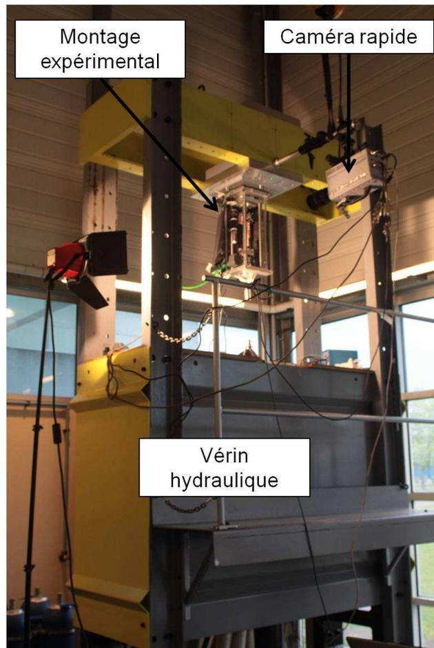
Figure 53 : Montage expérimental avec le vérin hydraulique, Photographie
