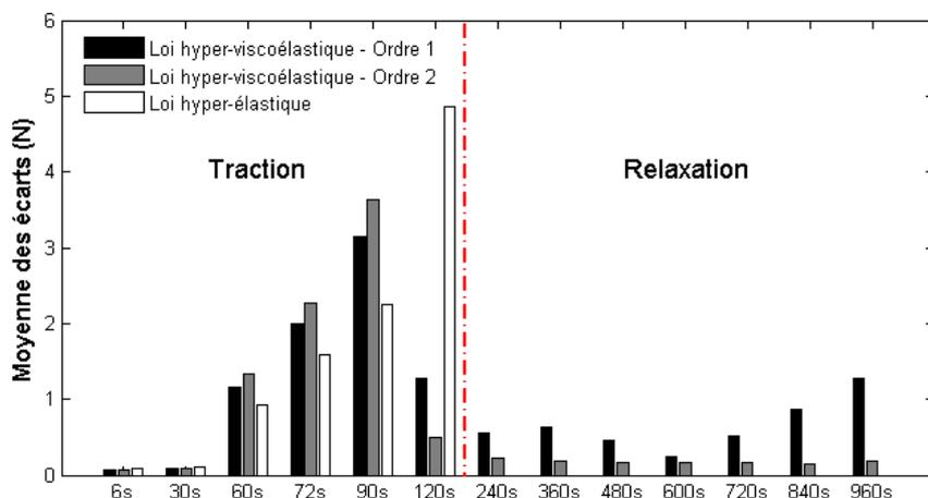
**Figure 36 : Comparaison des modèles hyper-viscoélastiques au 1<sup>er</sup> et au 2<sup>ème</sup> ordre pour différents instants sur la phase de traction (comparaison complémentaire avec la loi hyper-élastique) et sur la phase de relaxation**
