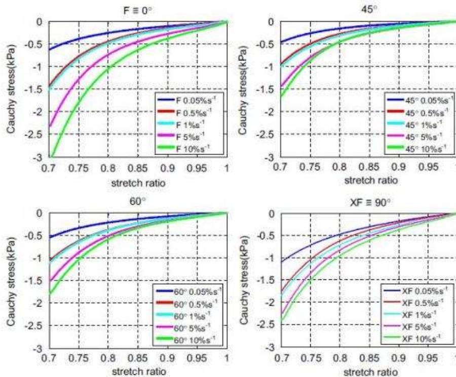
**Figure 12 : Courbes contrainte-elongation mettant en avant l'effet vitesse**
