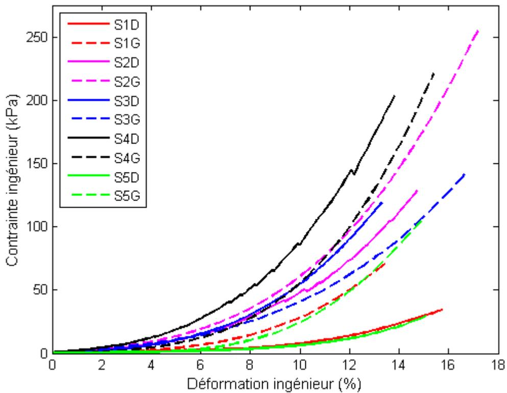
Courbes expérimentales de traction, modélisation avec un modèle exponentiel, modélisation avec une loi hyper-élastique, modélisation avec une loi hyper-élastique – méthode inverse.
