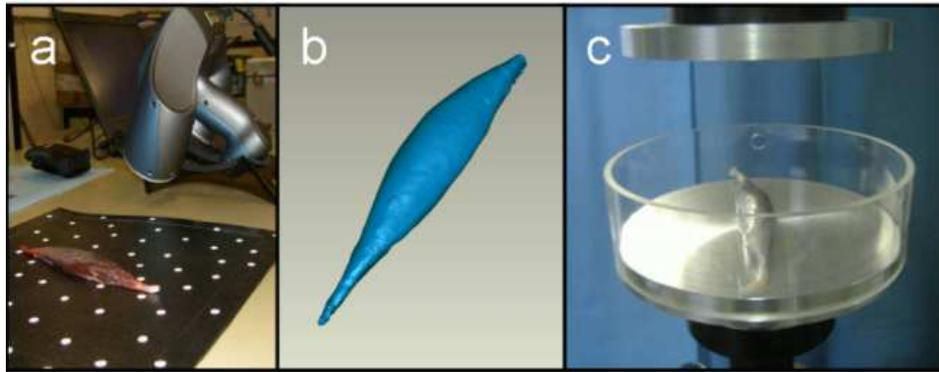
**Figure 18 : Compression d'un muscle de chien, acquisition géométrique (a), reconstruction 3D pour générer le modèle en éléments finis (b), l'essai de compression (c) D'après Gras et coll., 2011**
