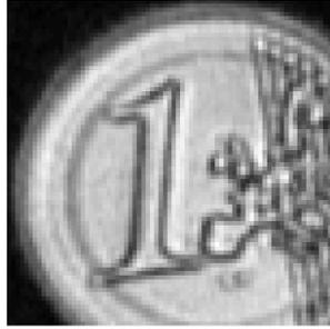
FIGURE 1.2 – Une pièce de un euro vue à la fréquence de 2 THz , pour illustrer la résolution des ondes térahertz (Données collectées en réflexion par J. Labaune (LOA/C2RMF)).
