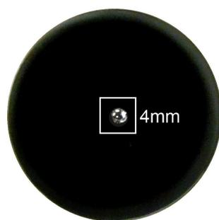
FIGURE 4.32 – Photographie de la goutte d'eau posée sur la pastille de silicium. Le carré représenté a une dimension de  $4 \times 4 \text{ mm}^2$  et correspond à la zone imagée. La pastille a un diamètre de 1 pouce (25.4 mm).
