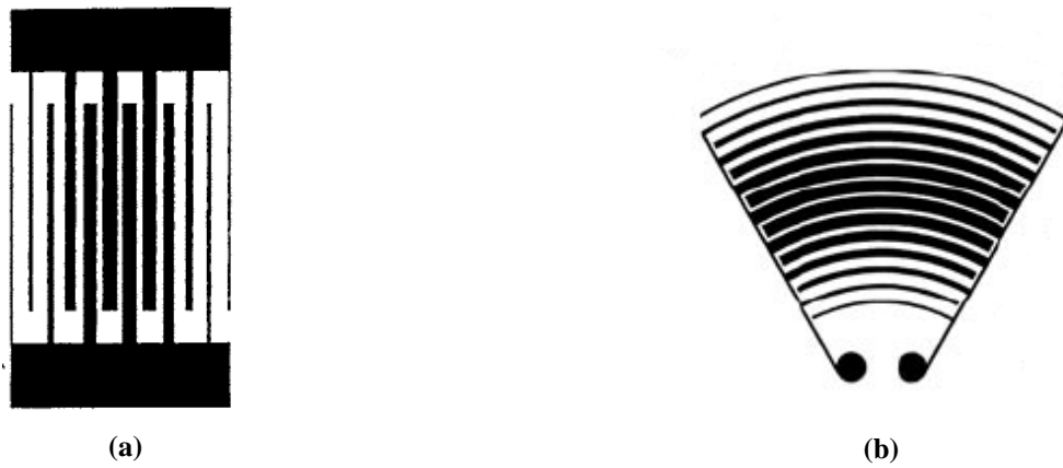
Figure 0-6: Schéma d'un traducteur interdigité (a) rectangulaire (b) circulaire [16].
