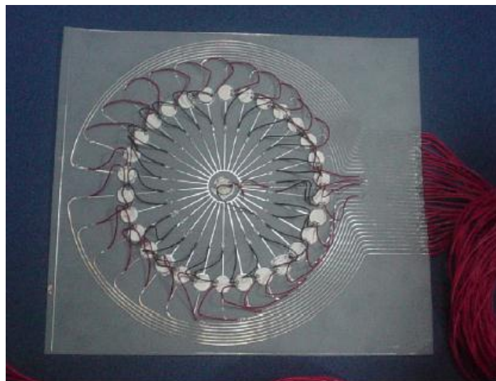
Figure 0-7: exemple d'une configuration circulaire de STMR [27], le traducteur émetteur est au centre de la configuration.
