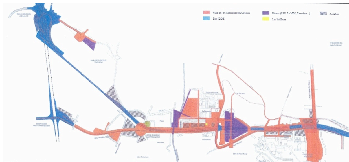
Figure 63: Le découpage des maîtrises d'ouvrage du projet L2 Nord. Extrait de (DDE13, 2004)
