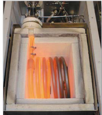
Figure II-4: Photographie du solénoïde du LINDSPRAY® HT 800/30 en fonctionnement
