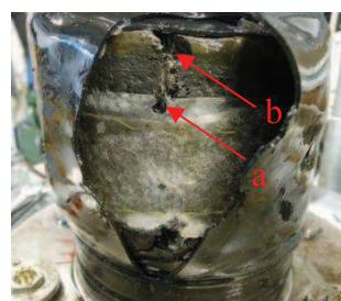
Figure 4-20 : Perçage de la membrane autour d'échantillon TO1 par les tiges de support des LVDTs a) Trou créé par les tiges b) Fissure traversant l'épaisseur de l'échantillon
