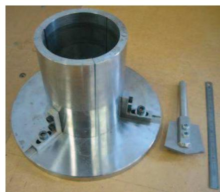
Figure 3-10 : Moule pour fixer l'échantillon et mèche à bois utilisée pour forer l'échantillon
