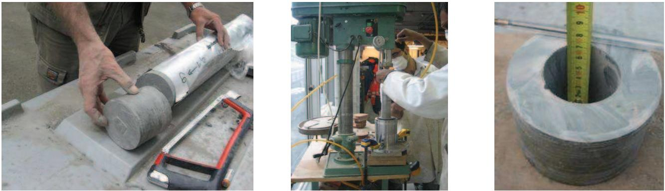
Figure 4-8 : Etapes de préparation d'un échantillon de l'argile à Opalinus
