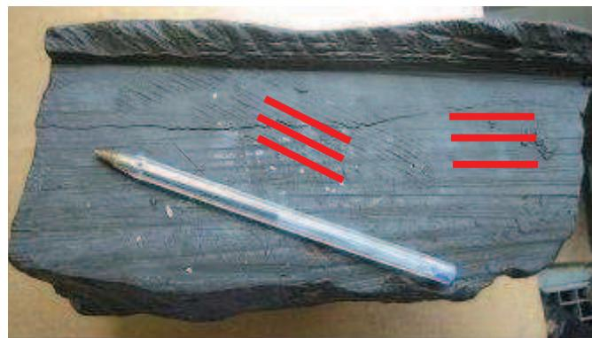
Figure 3-8 : Bloc de l'argile de Boom, la présence des fissures préexistantes
