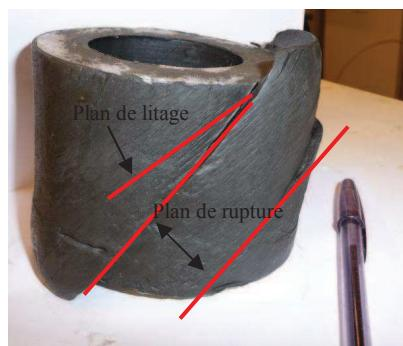
Figure 3-27 : Echantillon cisaillé de l'argile de Boom, TB0
