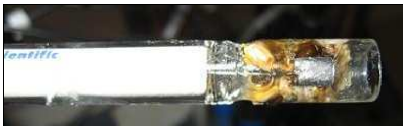
Figure 38 : Photographie du précipité observé sur la cellule de conductivité lors de la phase de lixiviation acide des colonnes TNU_OX.
