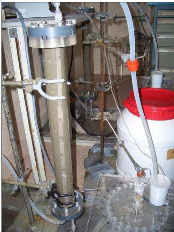
Figure 33 : Photographie du dispositif de circulation de la solution type "nappe" en circuit fermé. Les solutions de sortie de colonne sont collectées dans un récipient d'où elles sont pompées pour être réinjectées dans la colonne. Ce dispositif permet de faire circuler la solution type "nappe" en circuit fermé afin d'approcher une mise à l'équilibre de la solution interstitielle avec la phase minérale.
