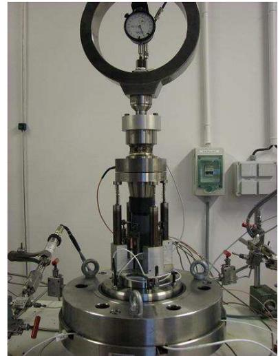
Figure III-39. Chargement – déchargement uniaxial sur cales.
