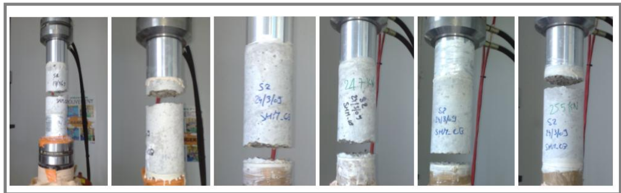
Figure 4.13 : Rupture des éprouvettes cylindriques en traction directe
