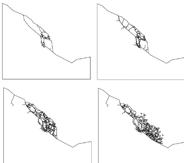
Figure 5. 10. Etapes évolutives de la modélisation du glissement 1991 de Randa avec la méthode hybride éléments finis-/discrets. La surface de rupture est prédéfinie dans cet exemple (Eberhardt, et al. , 2003)
