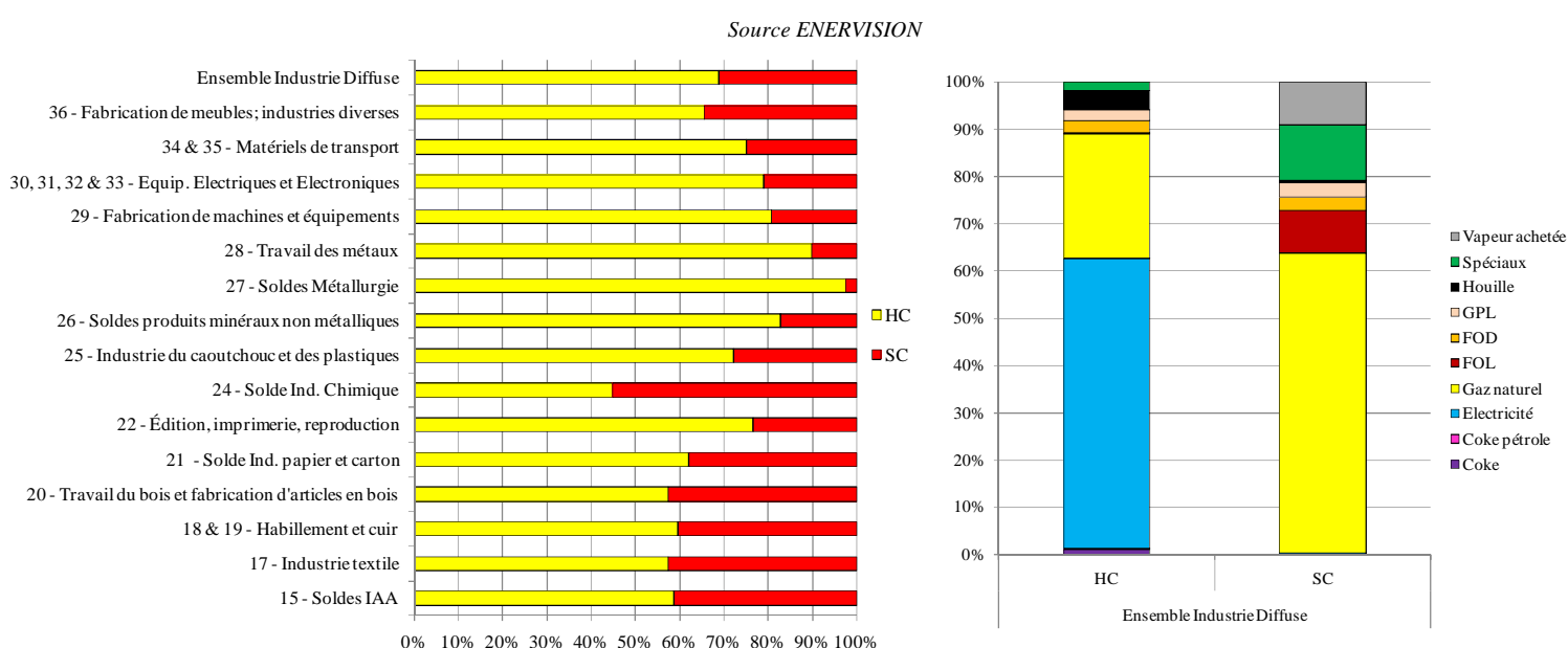
Fig. 32 : Répartition des combustibles sous chaudières et hors chaudière dans l'industrie diffuse.
