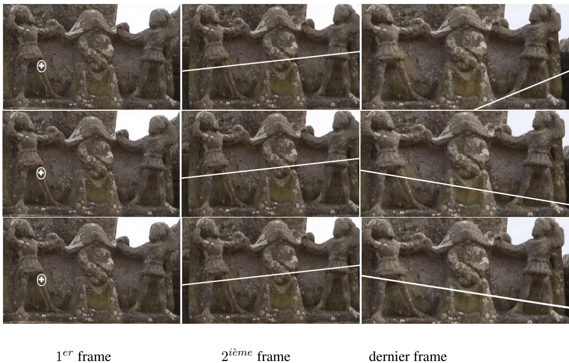
FIG. 2.9 – Cette figure illustre l'amélioration faite à chaque étape de notre algorithme. Si les caméras sont reconstruites sans imposer de contraintes de boucle, les droites épipolaires entre le premier et le dernier frame sont très imprécises (1 ère ligne). Elles deviennent bien plus précises une fois que l'optimisation linéaire séquentielle a été effectuée (2 nd e ligne). Enfin, le résultat est visuellement quasiment parfait une fois que l'enregistrement des homographies a été effectué (3 ième ligne). La figure peut être mieux visualisée en agrandissant le pdf.
