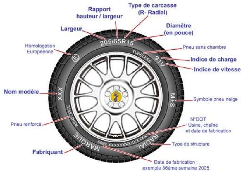
FIGURE 1.11: Constitution d'un pneumatique
