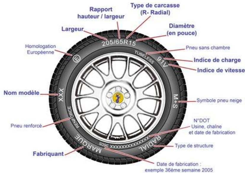
FIGURE 1.11: Constitution d'un pneumatique
