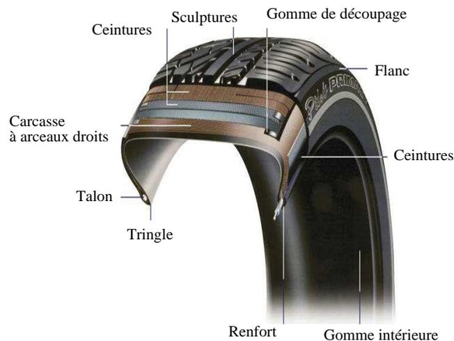
FIGURE 1.10: Constitution d'un pneumatique
