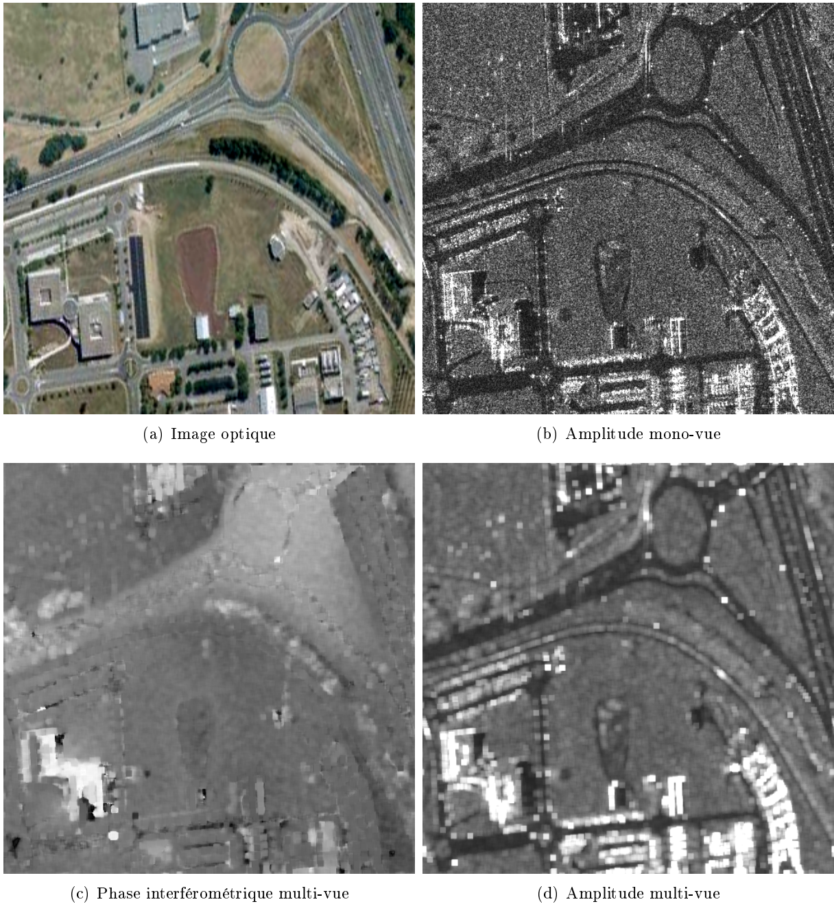
FIGURE 2 – (a) Une image optique, (b) l’amplitude RSO mono-vue et (c-d) l’amplitude RSO multi-vue et la phase RSO interférométrique multi-vue (obtenue par une moyenne dans une fenêtre glissante 7 \times 7 ) d’une zone urbaine de Toulouse (France). L’image optique a été acquise par le satellite Quickbird (©DigitalGlobe) et l’image RSO par le capteur aéroporté RAMSES (©ONERA). L’image d’amplitude mono-vue présente de fortes fluctuations tandis que l’image multi-vue présente de plus faibles fluctuations au prix d’une perte de résolution. En moyenne, l’amplitude est faible dans les zones lisses comme les rues, plus forte dans les zones rugueuses telles que l’herbe ou la végétation, et extrêmement forte autour des structures urbaines, des véhicules ou encore au pied des arbres où les échos radar sont les plus forts. La phase interférométrique est liée à la hauteur de la scène à des erreurs près apparaissant dans les régions de faible cohérence. Le filtrage multi-vue réduit ces erreurs au prix d’une perte de résolution.
