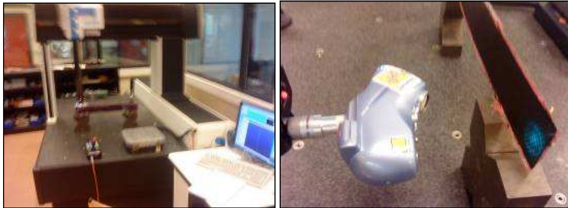
Figure 24: Machine de mesure tridimensionnelle - Capteur scanner KREON
