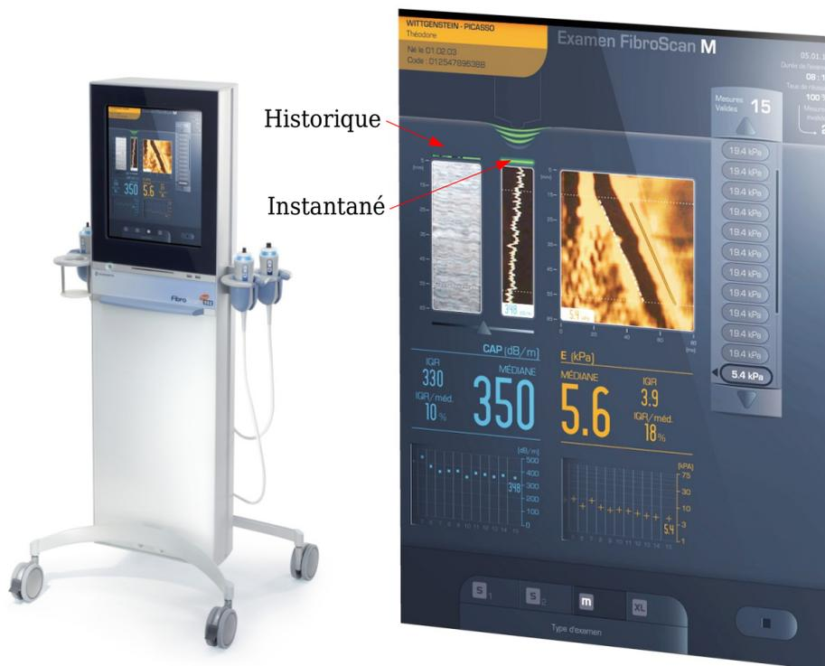
Figure III.19 : Implémentation de l'affichage du résultat de l'algorithme de détection de zones homogènes sur l'interface du Fibroscan.
