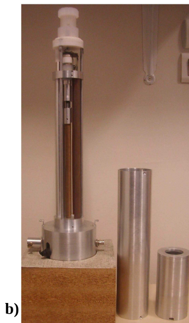
Figure 6: a): Verrerie avec réservoir à eau saturée en sel et système d'homogénéisation de température pour sonde RMN de gradient et haute résolution. b) : Sonde haute puissance multi-noyaux et son système de contrôle d'humidité
