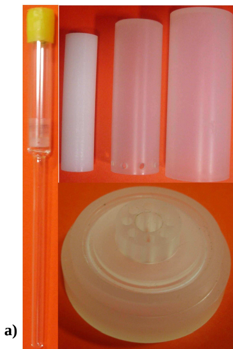
Figure 6: a): Verrerie avec réservoir à eau saturée en sel et système d'homogénéisation de température pour sonde RMN de gradient et haute résolution. b) : Sonde haute puissance multi-noyaux et son système de contrôle d'humidité
