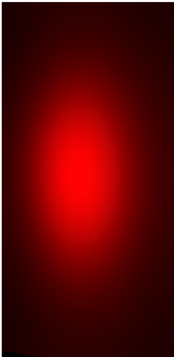
FIGURE 9.2 – Rendu simulé à l'aide du logiciel Blender à partir de la surface revêtue de la figure 9.1 ( 7.04\text{ mm} par 7.04\text{ mm} ) pour une source de lumière collimatée. La caméra est inclinée d'un angle de 60^\circ par rapport à la direction verticale. Le phénomène de diffusion de la lumière est pris en compte dans la simulation : l'indice optique de la peinture est n = 1.5 , le libre parcours moyen de la lumière en son sein étant fixé à 0.75\text{ mm} .
