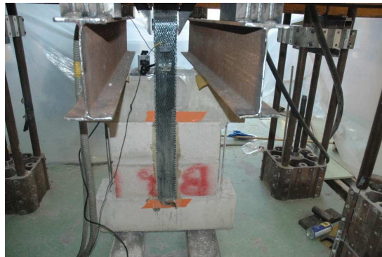
Figure 5.23 — Fixation de l'échantillon dans le bâti d'essai
