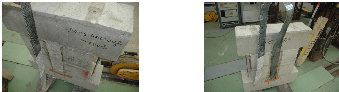
Figure 5.28 — Délaminage observé lors des essais sans ancrage
