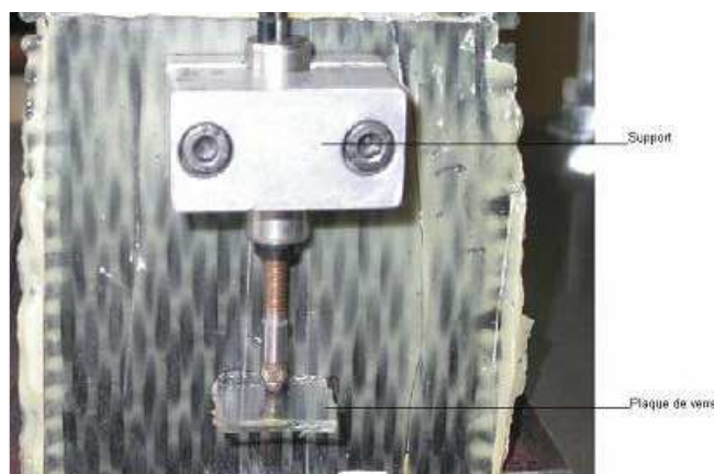
Figure 5.25 — Installation du capteur de déplacement sur le TFC
