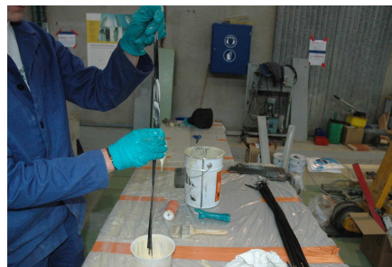
Figure 5.20 — Imprégnation des fibres de carbone
