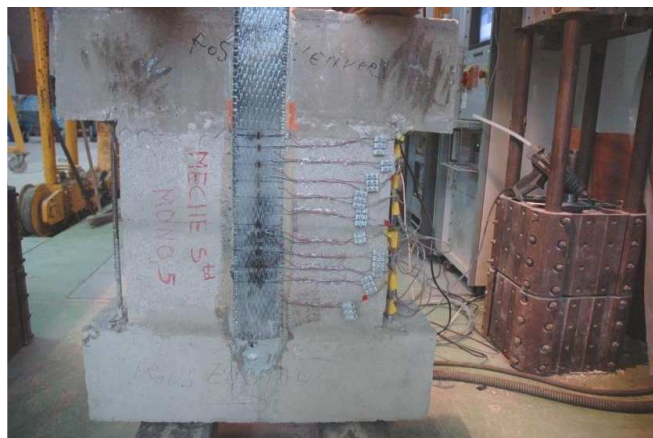
Figure 5.26 — Jauges de déformation
