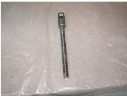
Figure 5.17 — Mèche à chas liée à une tige filetée
