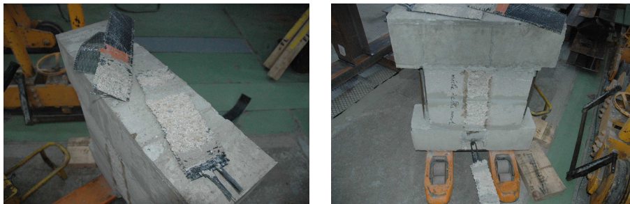
Figure 5.44 — Mode de rupture observé lors des essais avec ancrage de type mèche à chas
