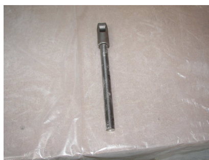
Figure 5.9 — Tête à chas liée à une tige filetée \phi 16
