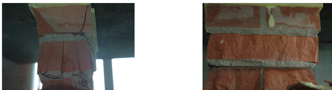
Figure 3.12 — Mode de rupture de l'échantillon B_2
