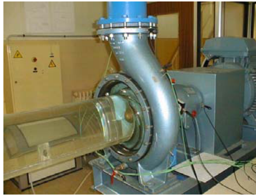
FIGURE 2.2 : Banc d'essais de pompes centrifuges du DynFluid.
