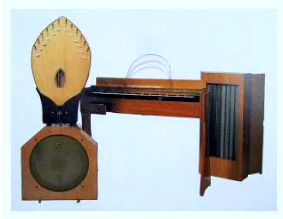
FIG. 2.3 – Les Ondes Martenot avec leurs diffuseurs
