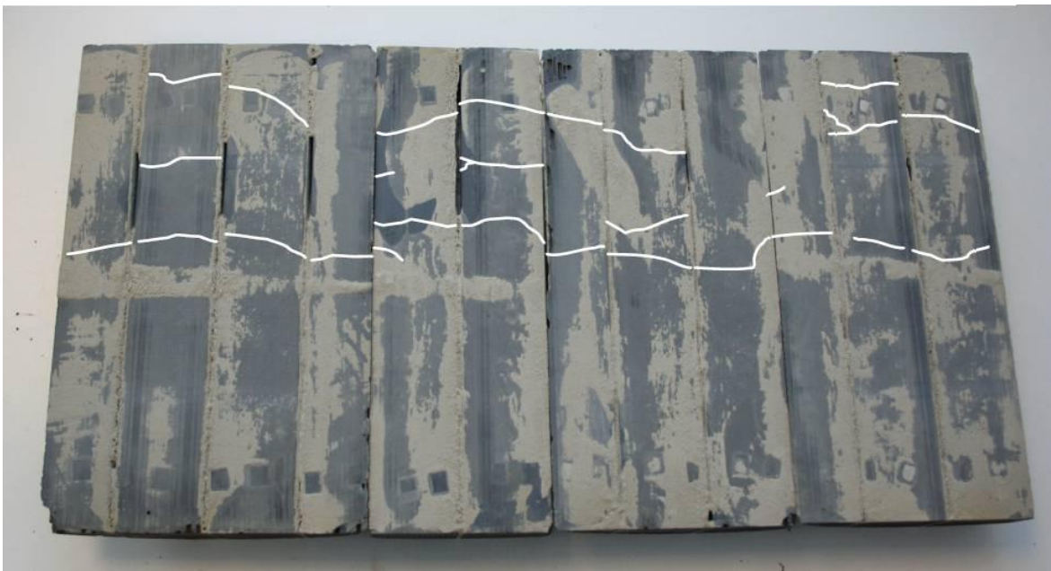
Figure 14 : Spécimen fissuré après régénération sévère au-delà de la « MLS » (faces des segments constituant le FAP)
