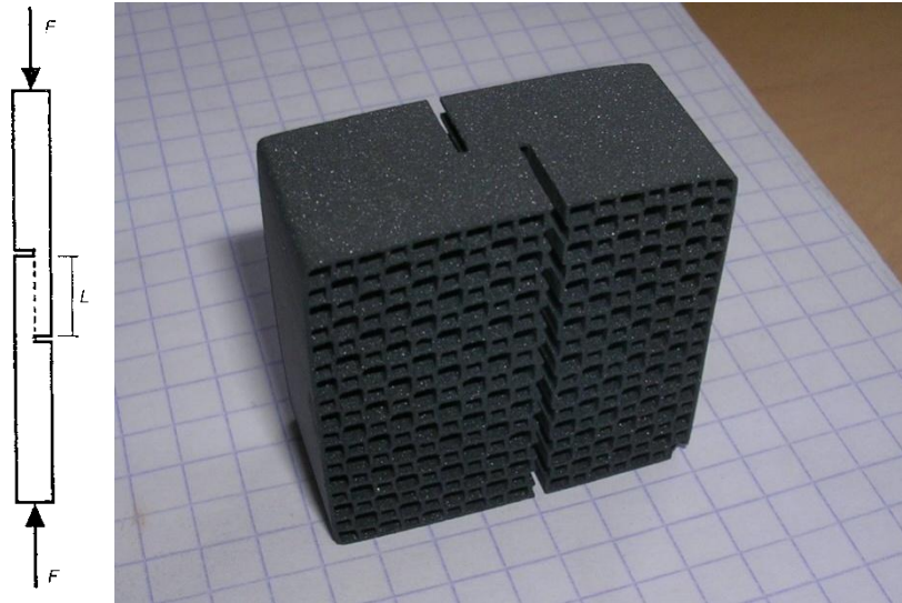
Figure 94 : Principe de l'essai de cisaillement sur éprouvettes à double entaille (à gauche), éprouvette de la présente étude (à droite)
