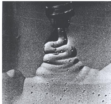
Figure 2.2: Écoulement d'un jet d'huile flottant sur l'eau. (Cruickshank 1981 [18])
