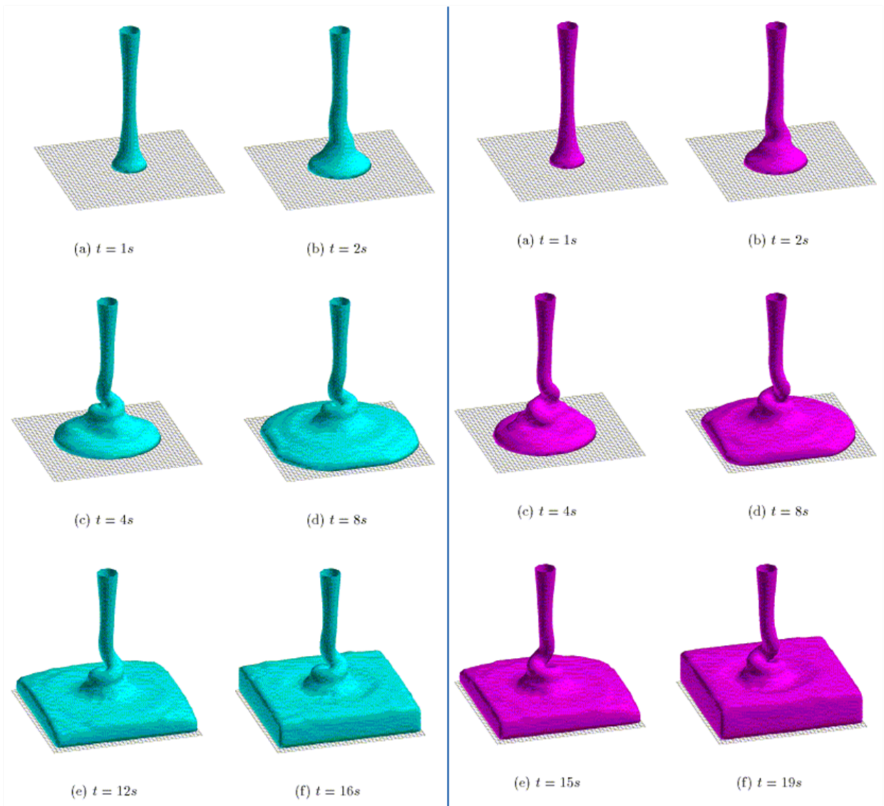
Figure 2.16: Simulation du "Fluid Buckling" avec du propergol à l'aide de la méthode TVD SUPERBEE avec un injecteur centré à gauche et décentré à droite. [47]
