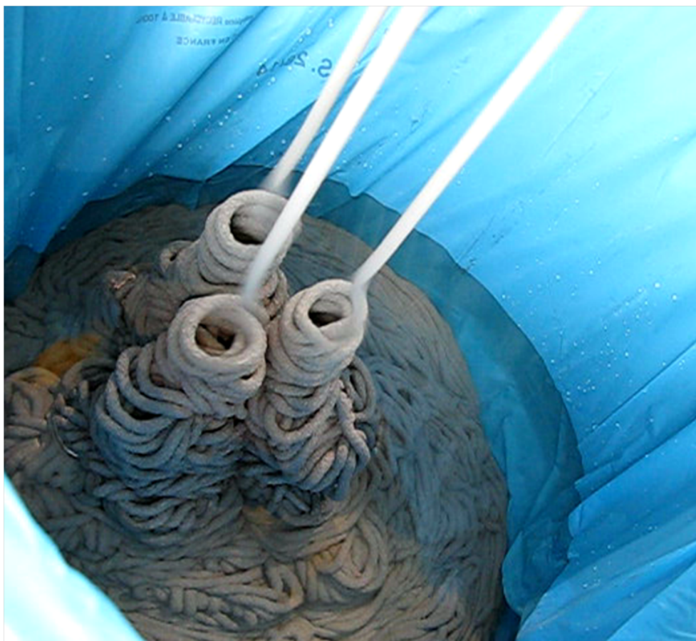
Figure 1.7: Ecoulement de propergol : Apparition d'oscillations toroïdales appelées : Fluid Buckling.
