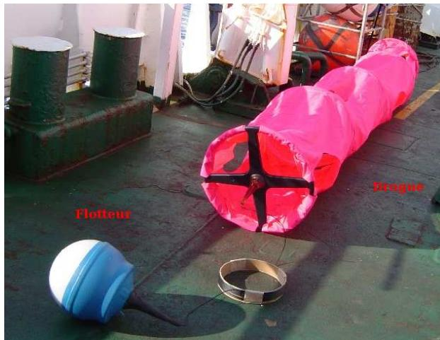
FIGURE 2.4 – Photo d'un drifter avec sa drogue déployée.
