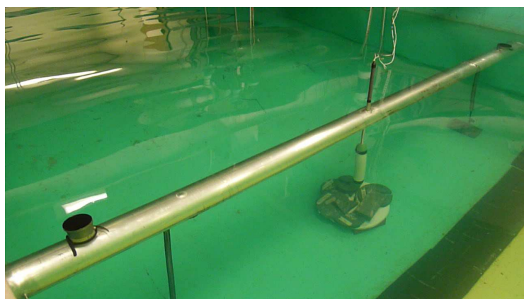
FIGURE 5.25 – Le système mis à l'eau avant les essais. On distingue au centre du cylindre le générateur et le système de guidage des fils électriques, et de chaque côté les deux ressorts latéraux surmontés des boîtiers contenant les accéléromètres.
