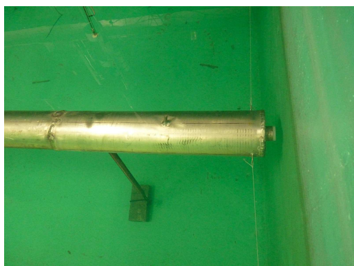
FIGURE 5.26 – A gauche : le générateur linéaire ancré par une plateforme circulaire au fond du bassin. A droite : le système de guidage étanche des fils électriques.
