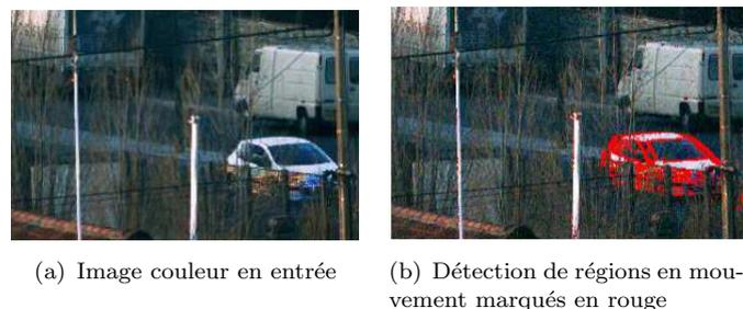
FIGURE 2.11: Exemple d'application d'une détection de régions en mouvement avec un seuil à 60
