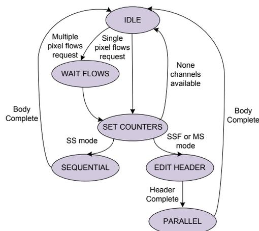
FIGURE 5.20: Machine à états du *DFR Controller*
