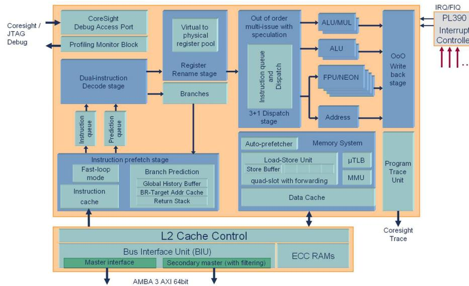
FIGURE 2.28: Architecture du processeur Cortex-A9 (ARM) [62]
