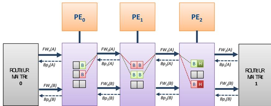
FIGURE 4.24: Exemple de deux paquets circulant avec trois canaux virtuels
