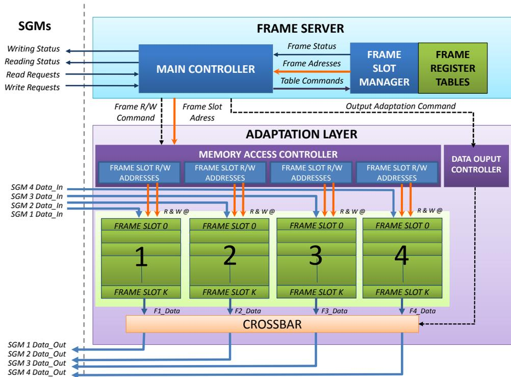
FIGURE 6.15: Architecture du Frame Buffer System avec 4 SGMs
