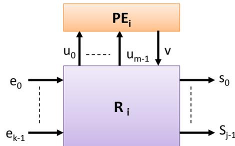
FIGURE 5.2: Schéma des entrées et sorties du routeur  $R_i$
