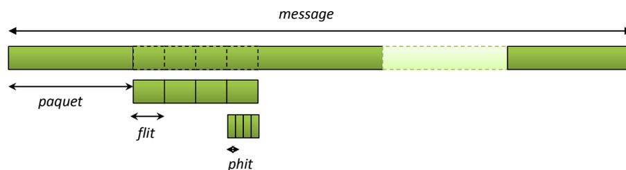
FIGURE 3.5: Structure d'un message dans un réseau NoC [14]
