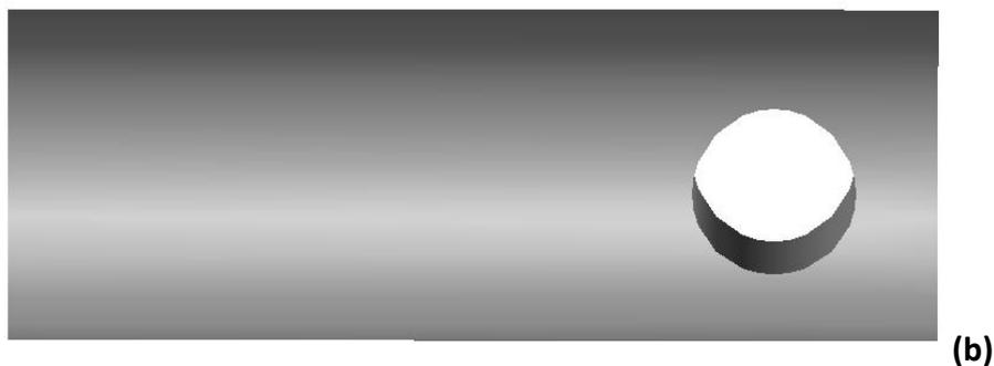
**B-1 : Prélèvement de carotte dans la partie utile de l'éprouvette de torsion représenté : (a) en 2D et (b) en 3D**
