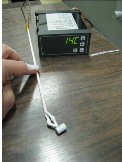
**Figure II-8 : Thermocouple soudé à l'éprouvette**
