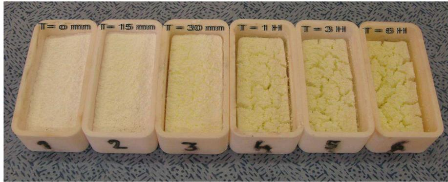
FIG. 1.14 – Photo des moules à différents temps de recuit. (Images société Rhodia).
