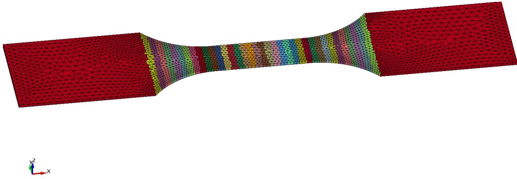
FIGURE 5.2: Maillage de l'éprouvette haltère intégré dans l'épaisseur
