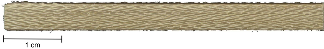
FIGURE 4.26: Photographie d'une éprouvette de flexion 3 points après polissage
